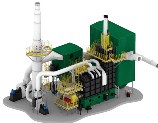
Figura 9: Esboço do sistema de geração de gases quentes a biomassa
