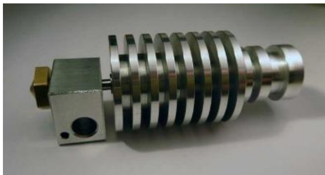
Figura 19 - Bico extrusor com aletas metálicas
