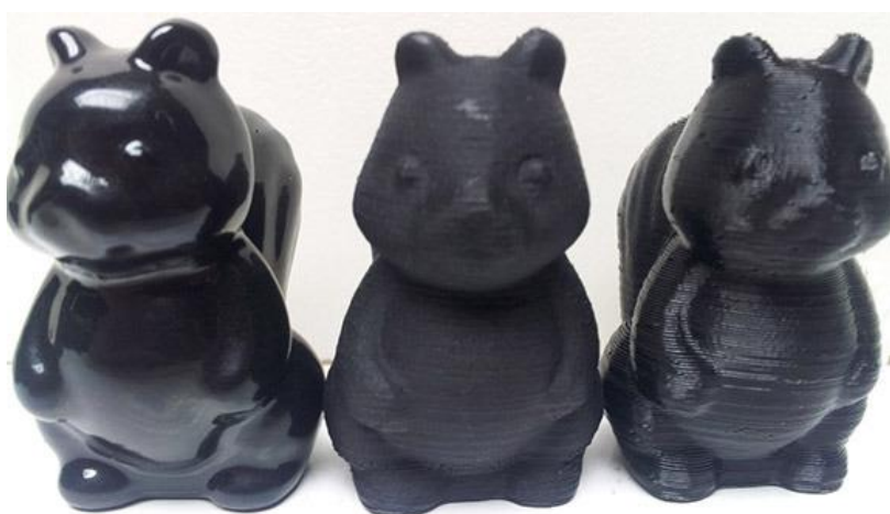
Figura 26 - Peça tratada com acetona pura, removedor de esmalte e sem tratamento
