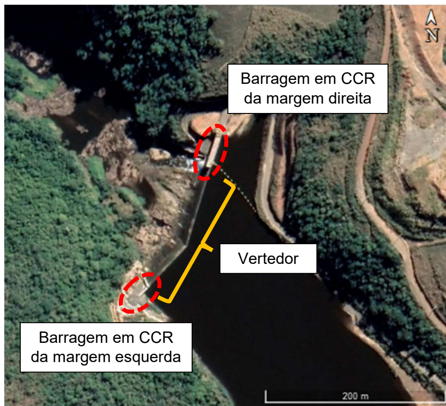
Figura 3.3 – Imagem aérea da região da barragem da PCH Macacos, com indicação da barragem e do vertedor
