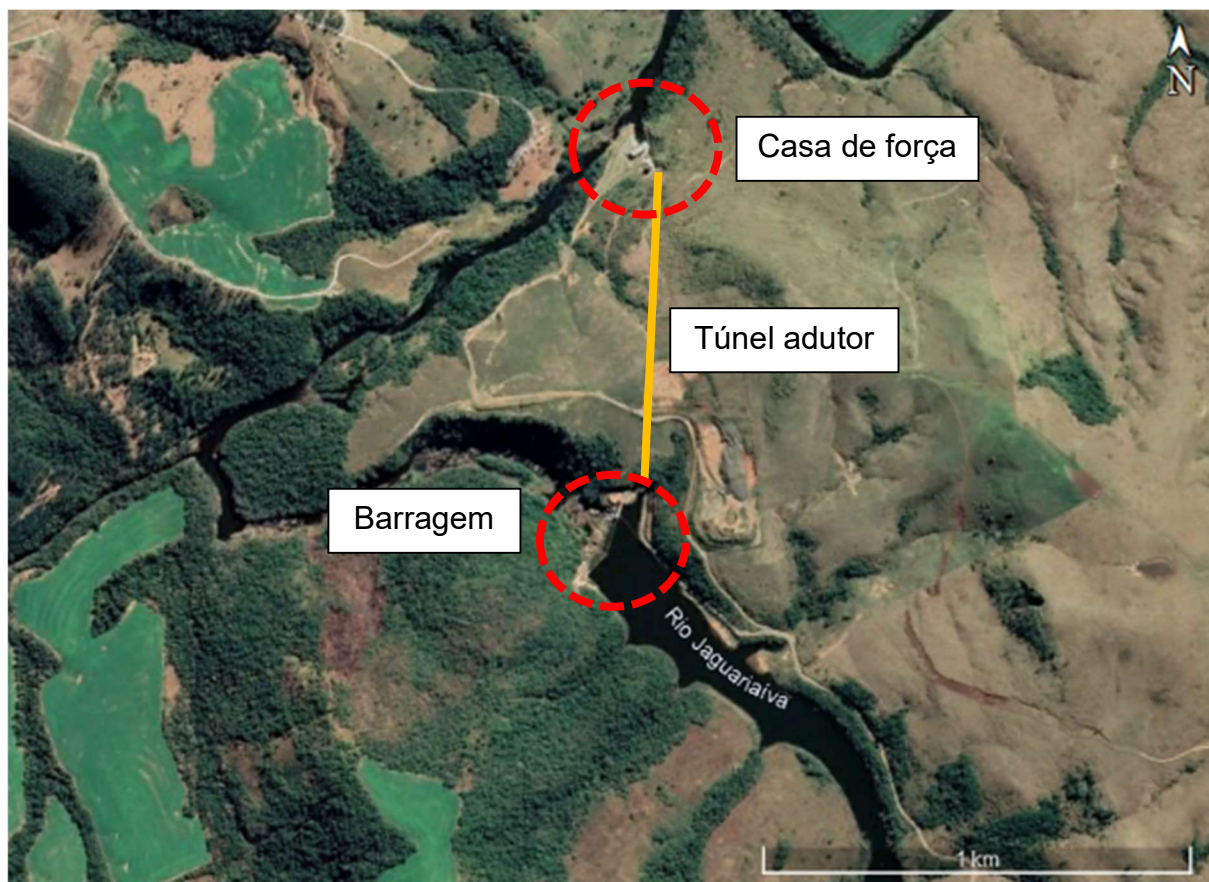
Figura 3.2 – Imagem aérea da PCH Macacos, com indicação das regiões da barragem e da casa de força, além do túnel adutor
