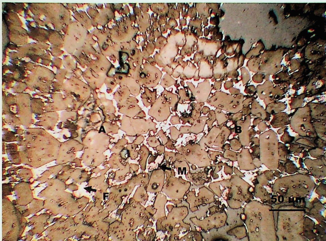
Fotomicrografia 1 - Aspecto geral do clínquer - Ataque com \text{HNO}_3 - Etapa com co-processamento de pneus inteiros e picados (A=alita, B=belita, M=MgO e F=fases intersticiais)
