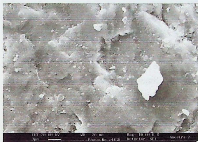
Figura 43 Amostra tipo 02 – Regiões ricas em Ca apresentam-se com cores escuras, possível feição ligada a desmistura (representativas de material mais calcítico dentro de uma massa dolomítica)
