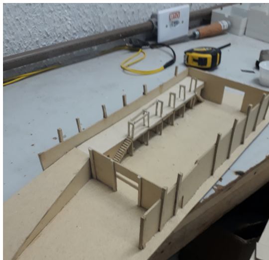
Fig. 13 Uma das maquetes do galpão canteiro escola com a proposta de construção de um mezanino que incorporaria estruturas para atividades em altura, um novo espaço de depósito e almoxarifado, novas salas de aula, além de maior integração com o espaço externo e organização do espaço interno. Fonte: arquivo pessoal, 2018.
