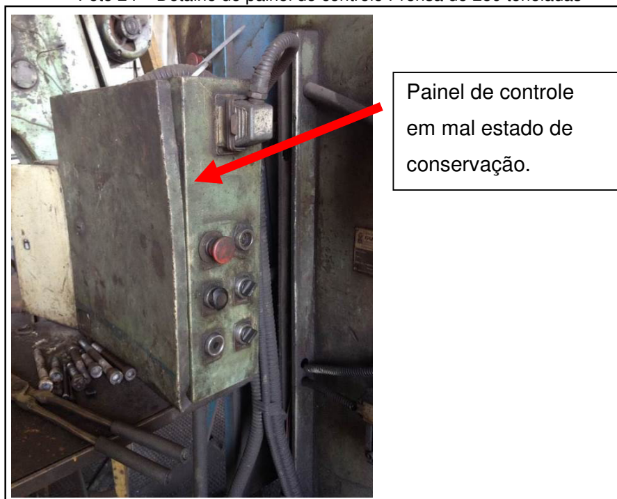
Foto 24 – Detalhe de painel de controle Prensa de 250 toneladas
