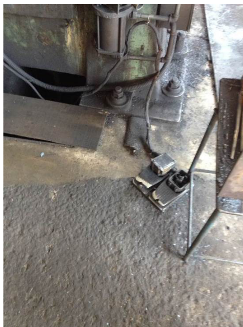
Foto 26 – Detalhe de pedal para acionamento da Prensa
