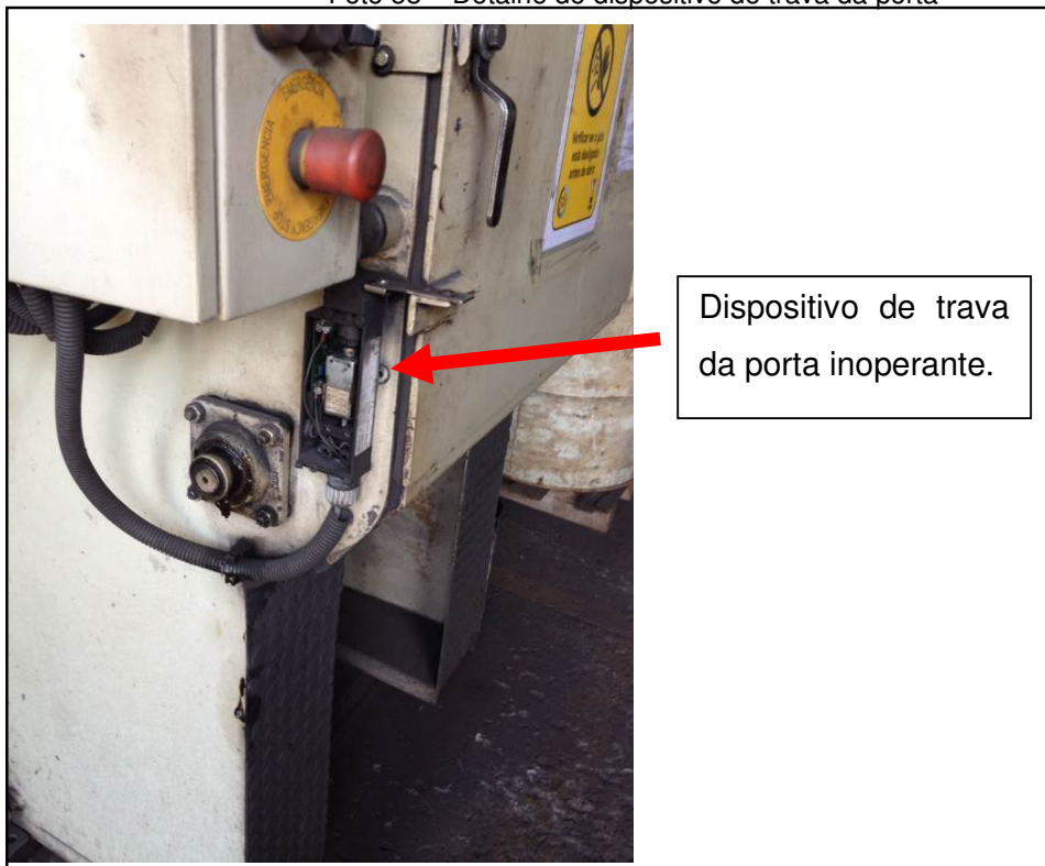
Foto 58 – Detalhe do dispositivo de trava da porta
