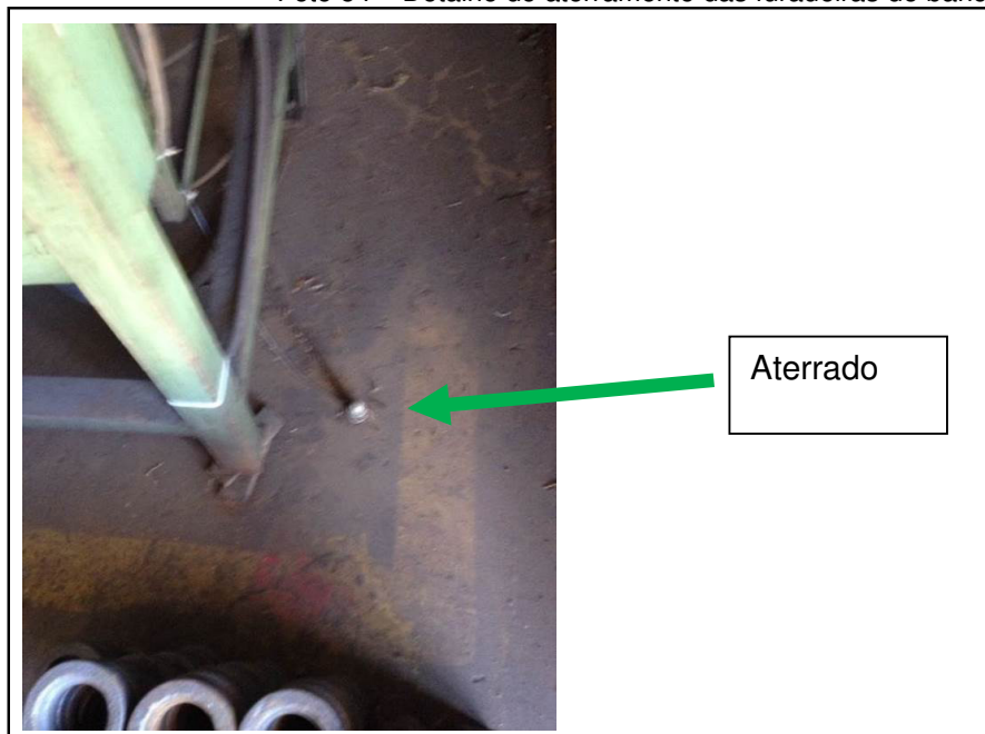
Foto 54 – Detalhe do aterramento das furadeiras de bancada
