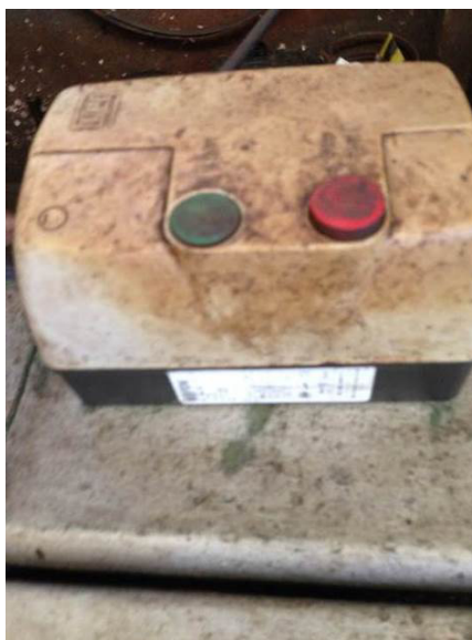
Foto 8 – Detalhe do dispositivo de partida e parada
