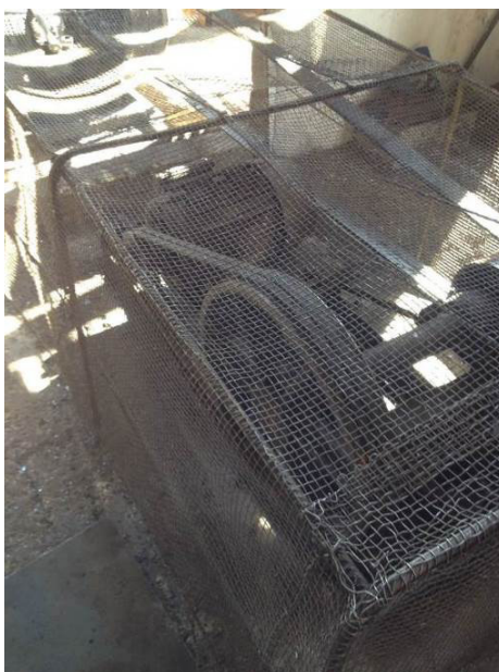
Foto 38 – Proteção do motor e correia do Marteleto grande
