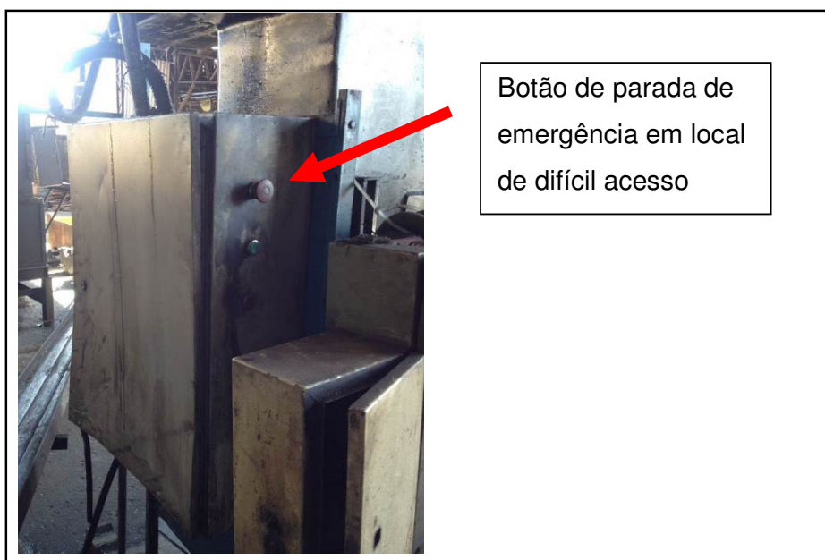
Foto 25 – Detalhe de dispositivo de parada de emergência
