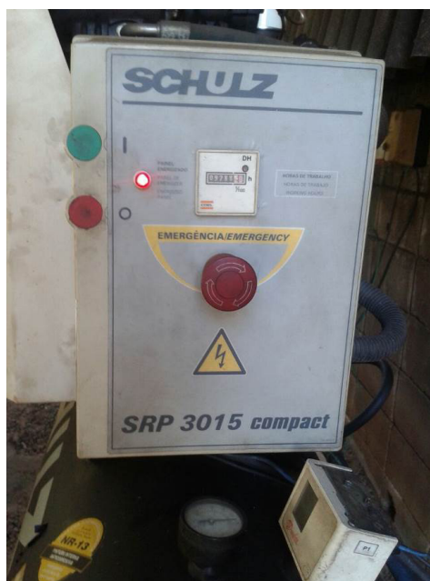
Foto 63 – Detalhe do dispositivo de parada de emergência
