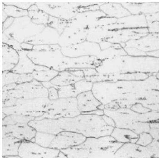
Figura 31 – Presença relevante de cementita (preta) em uma matriz de ferrita (branca)
