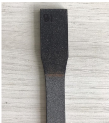
Figura 6 - Imagens corpo de prova com resíduo PPRMC depois da exposição
