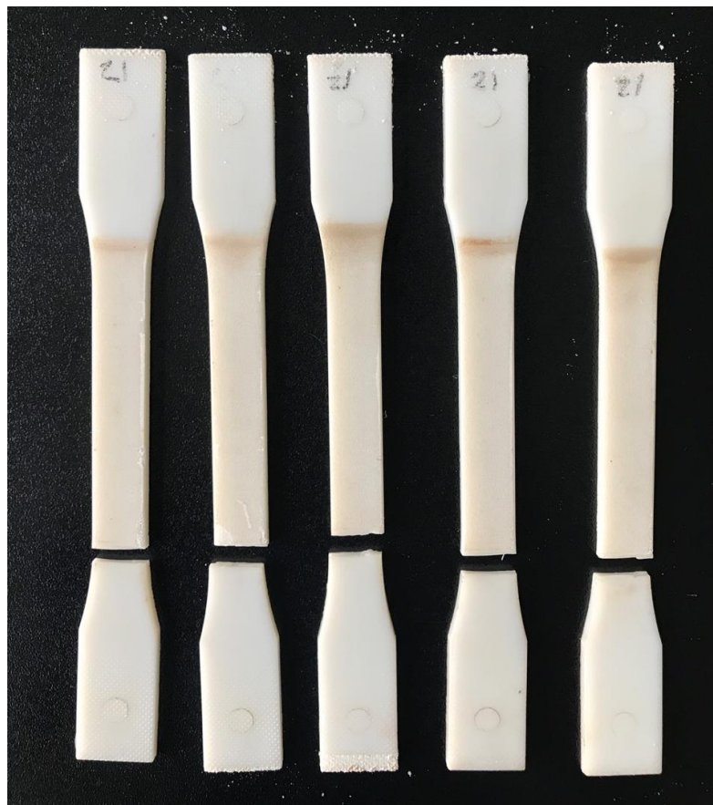
Figura 10 - Imagens da ruptura do corpo de prova sem resíduo PPM no ensaio de tração realizado após a exposição ao meio ambiente
