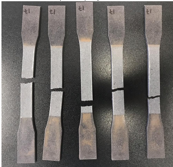
Figura B.4 - Imagens da ruptura do corpo de prova sem resíduo PPRM no ensaio de tração realizado após a exposição ao meio ambiente
