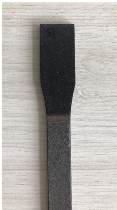
Figura A.1 - Imagens corpo de prova com resíduo PPR depois da exposição
