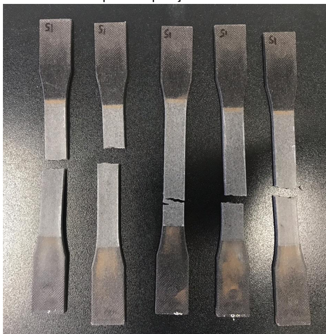
Figura B.2 - Imagens da ruptura do corpo de prova sem resíduo PPR no ensaio de tração realizado após a exposição ao meio ambiente
