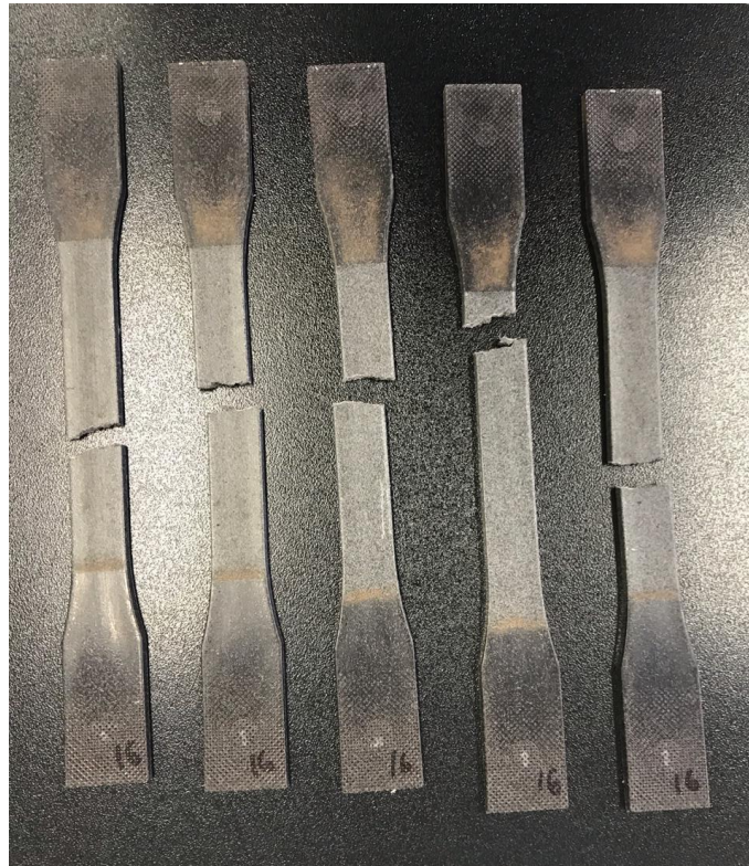
Figura B.3 - Imagens da ruptura do corpo de prova sem resíduo PPRC no ensaio de tração realizado após a exposição ao meio ambiente
