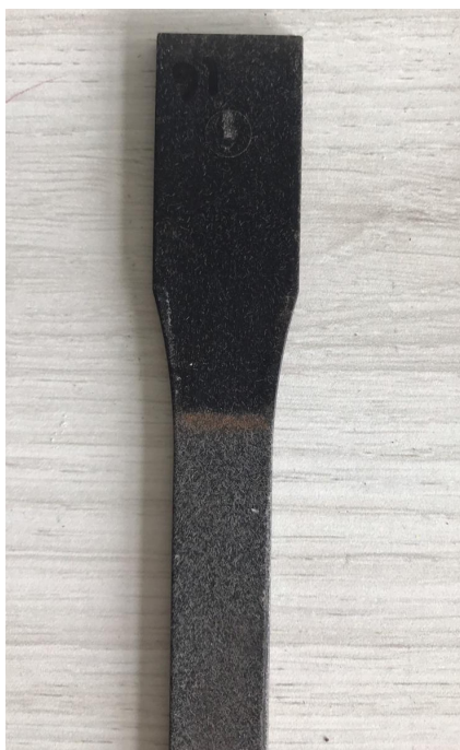
Figura A.2 - Imagens corpo de prova com resíduo PPRC depois da exposição
