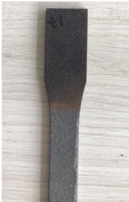
Figura A.3 - Imagens corpo de prova com resíduo PPRM depois da exposição
