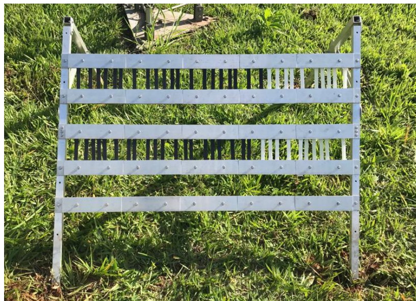
Figura 1 - Disposição dos corpos de prova para ensaio de envelhecimento no intemperismo natural
