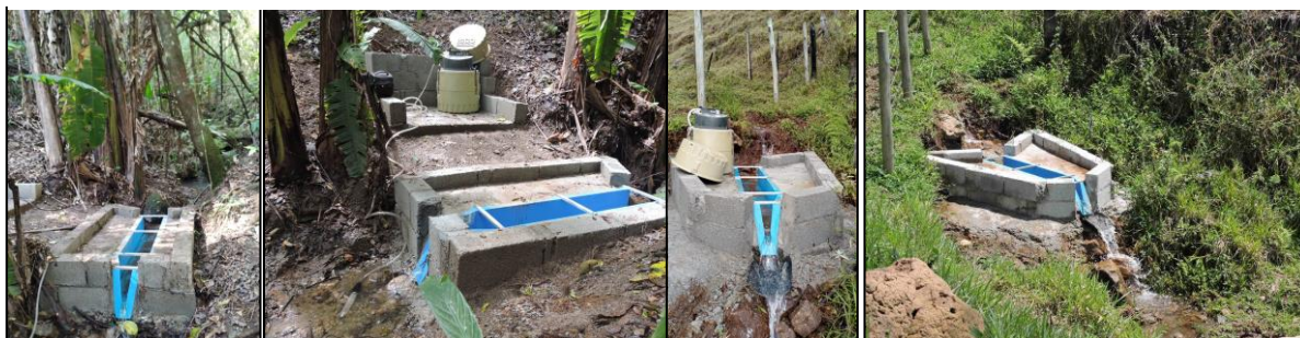
Figura 6 – Vertedouros tipo HS instalados na floresta (esquerda) e na pastagem (direita)
