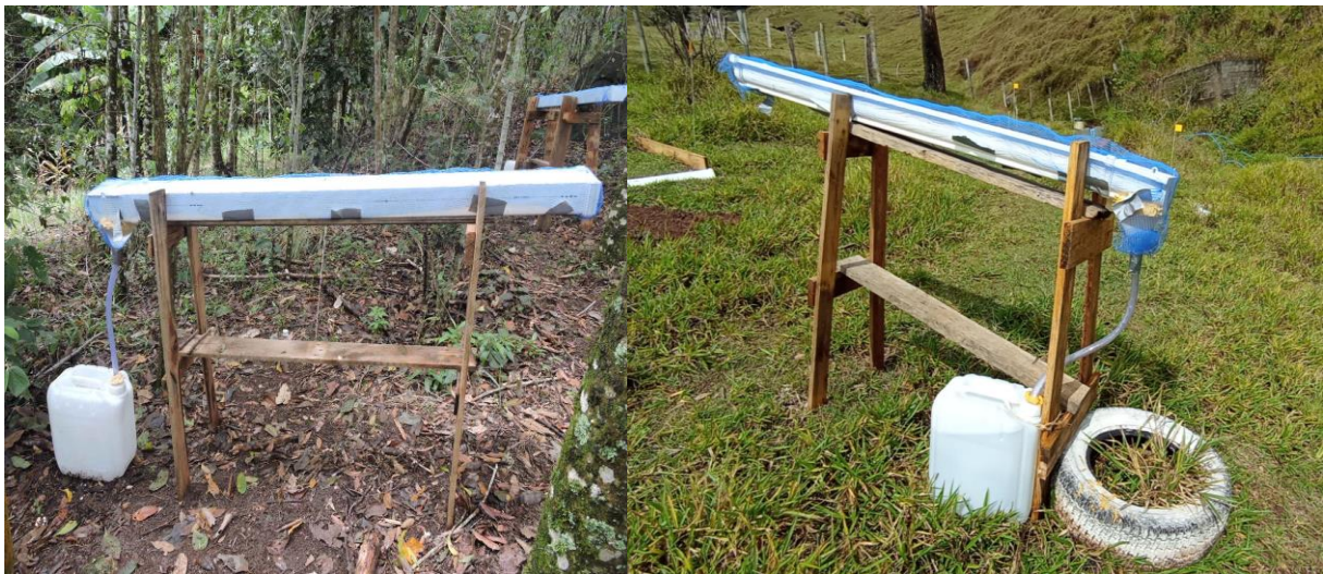
Figura 5 - Calhas instaladas na floresta (esquerda) e na pastagem (direita)
