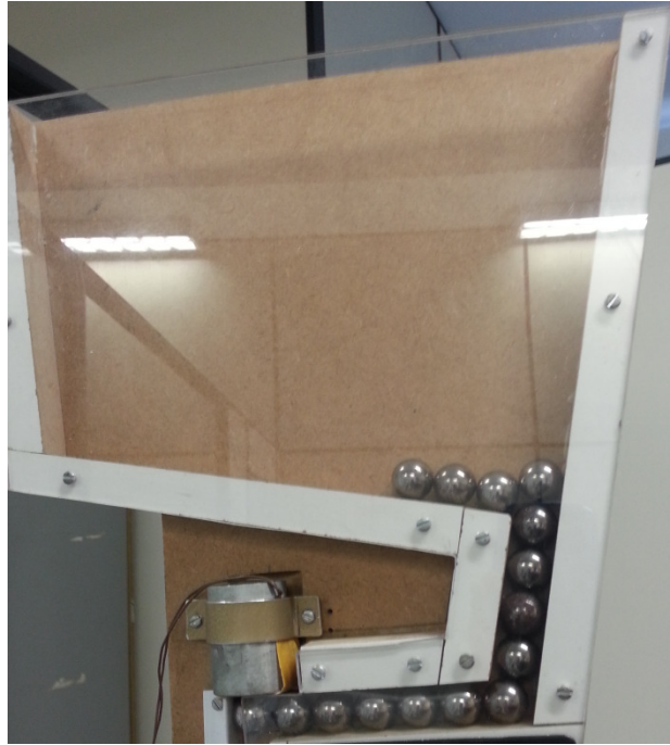
Figura 5: Suporte para as Esferas construído em forma cônica.
