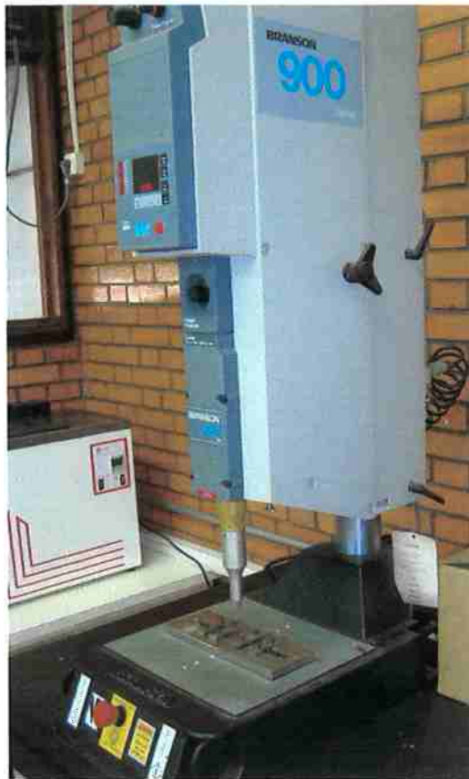
Figura 16 - Equipamento de soldagem utilizado
