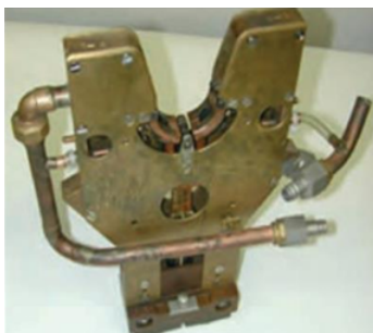
Figura 24 – Representação do tipo de indutor utilizado no processo de têmpera dos virabrequins em estudo.
