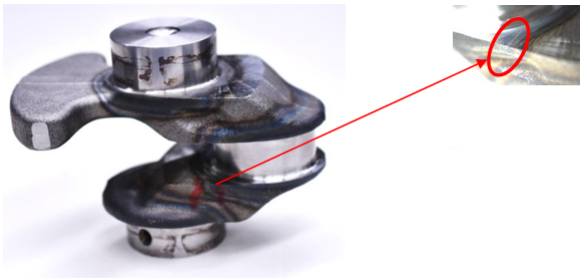
Figura 37 – Localização da nucleação da trinca na amostra 2 pós ensaio de flexão. Região do Pl4
