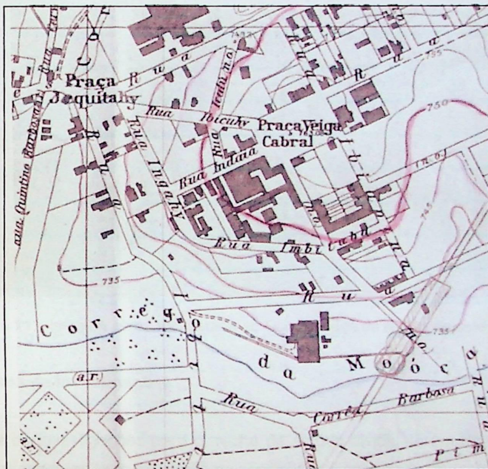
Figura 10 – Mapa Topográfico antigo (modificado, 1934) com o esboço do poço de estação e dos túneis.
