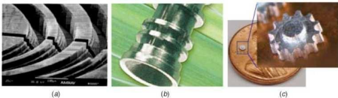
Figura 2 - (a) Canais microfresados com paredes em degrau, (b) componente neurovascular, e (c) microengrenagem.
