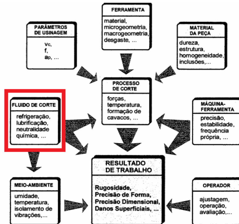
Figura 1 - Fatores de influência sobre a precisão da peça na usinagem de ultraprecisão.
