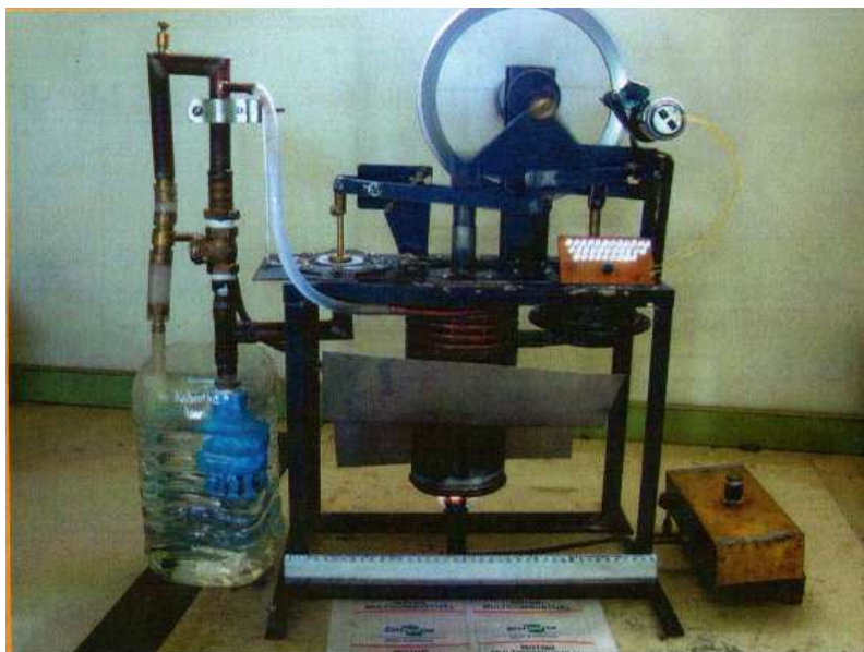
Figura 20 – Foto de protótipo de motor Stirling. Fonte: EMBRAPA, 2010.
