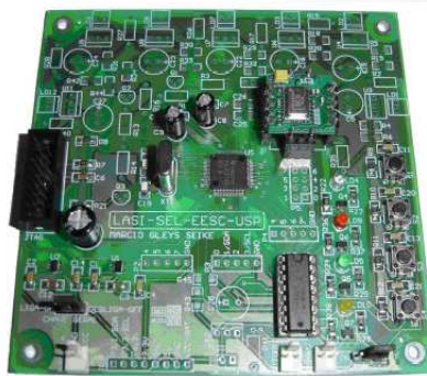
Figura 5.2: Imagem da placa controladora utilizada nos robôs.
