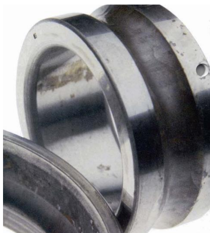
Figura 3.11 Corrosão na interface do rolamento com o eixo
