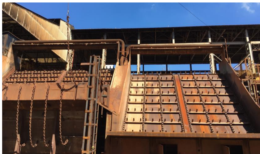
Figura 27 – Entrada da moenda de cana-de-açúcar. Aqui se inicia o processo de transformação da cana em açúcar ou etanol.
