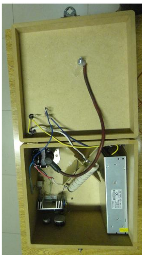
Figura 80 O equipamento bioeletrográfico construído. Em cima, o equipamento fechado, com a saída da bobina em um terminal metálico no centro da tampa e a saída aterrada em um terminal pontiagudo livre. O botão verde é para ativar o circuito de alta tensão. Os botões na frente controlam os potenciômetros do LM555N, portanto ajustam a frequência de chaveamento. Embaixo há o equipamento aberto à esquerda (mostrando a bobina, a fonte CC e o dissipador do transistor e um divisor resistivo menor que conservou-se para operar abaixo do usual da bobina), e o terminal de descarga à direita (a superfície dielétrica está em contato com o terminal fixo de alta tensão; o terminal terra é conectado à malha condutora do ITO, que está em contato com a moeda).
