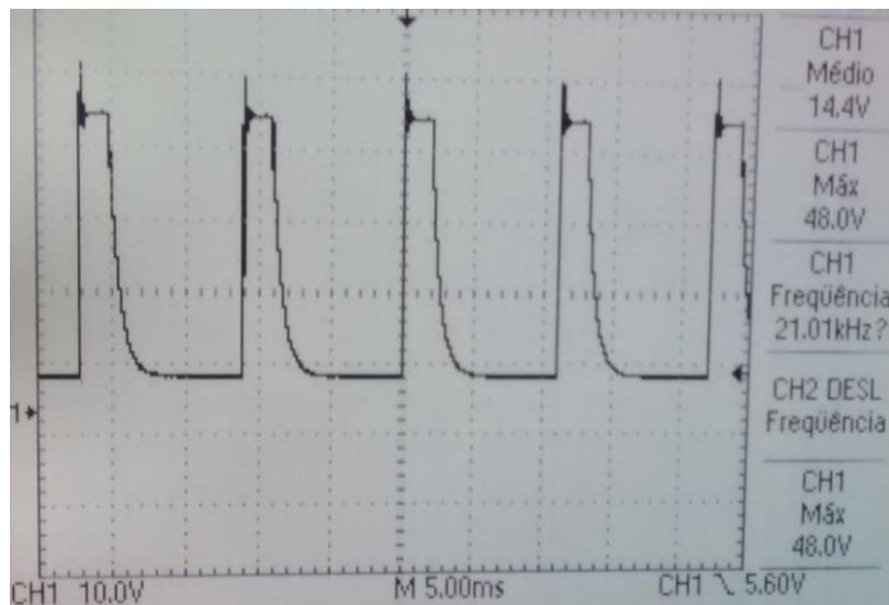
Figura 76 Forma de onda da tensão no indutor primário mostrando o efeito de carregamento do indutor. Frequência de chaveamento: aproximadamente 90 Hz e Ton aproximadamente 9 ms, possibilitando carregar totalmente o indutor. A frequência lida na lateral direita é um valor incorreto, pois mescla-se com a alta frequência do pico de tensão, que não aparece por causa da escala de tensão e de tempo escolhida.
