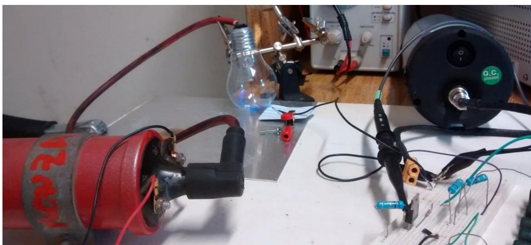
Figura 58 Descarga corona em uma lâmpada incandescente para simular um “globo de plasma”. Como os terminais internos são muito finos, a descarga corona é intensa. A cor da descarga é violeta, porém foi distorcida para azul pela câmera. O filamento de tungstênio da lâmpada está rompido, porém isto não afeta o efeito.
