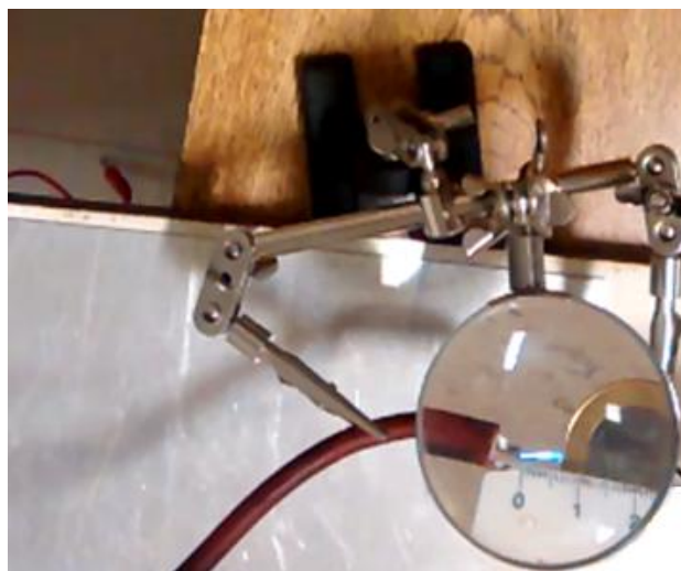
Figura 57 Faísca obtida com aproximadamente 0,8 cm. Para estimar a tensão, a configuração foi tida como ponta-ponta (devido a pequena espessura da moeda), e o valor obtido foi 8 kV (a ruptura para esta configuração ocorre com 10 kV/cm).
