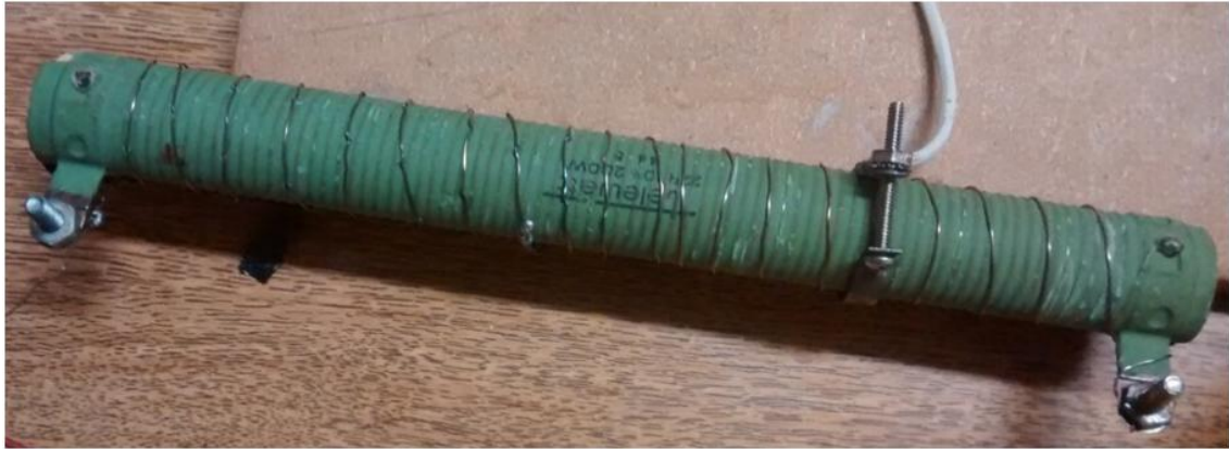
Figura 63 Potenciômetro ( R_{série} ) construído com resistência de chuveiro para suportar correntes de pelo menos 8 A, operando com arrefecimento forçado.
