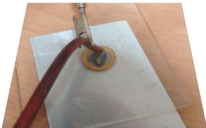
Figura 78 O halo corona de uma moeda produzido com a montagem do teste 3. O halo formou-se no contorno, mas não aparece na superfície. Pela reflexão do eletrodo planar, supôs-se que o brilho superficial aparece no lado deste eletrodo.
