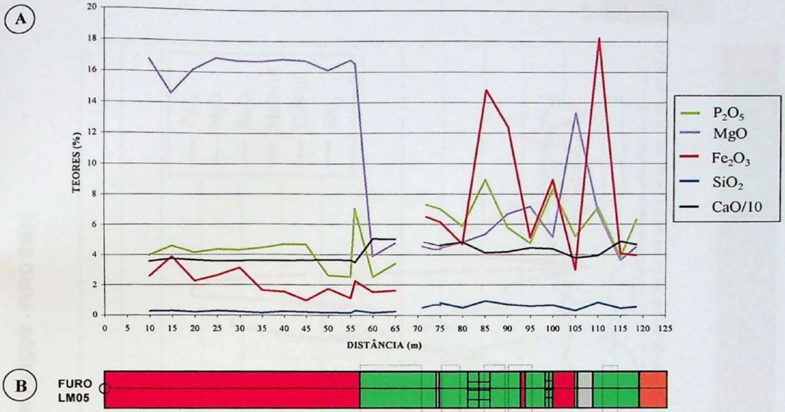
Figura 7: Gráfico da variabilidade dos óxidos (A) ao longo do perfil do furo de sondagem LM05, acompanhado do correspondente "log" (B).
