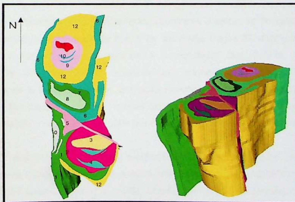
Figura 4: Mapa geológico e modelo tridimensional do corpo carbonatítico (Fonte: Saito et al. , 2004). Unidades geológicas: 1- Carbonatito Periférico Sul (CPS); 2- Carbonatito Calcítico Sul (CCS); 3- Carbonatito Oxidado (COX); 4- Zonas com Foscoritos Sul (FCS); 5- Zona de Falha (ZFA); 6- Carbonatito Intermediário (CBI); 7- Carbonatito Foliado (CBF); 8- Carbonatito Branco (CBR); 9- Carbonatito Norte (CBN) ; 10- Zonas com Foscoritos Norte (FCN) ; 11- Carbonatito Dolomítico (DOL) ; 12- Zonas de Xenólitos (XENorte, XELeste, XESul); 0- Corpos de Jacupiranguito (JAC).
