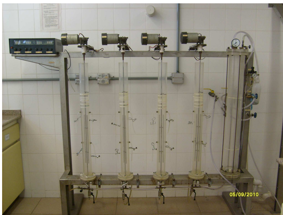
Figura 13-Flotateste utilizado na pesquisa.
