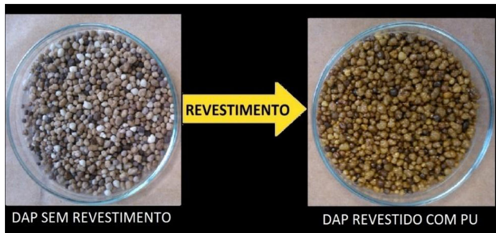
Figura 6. Comparação entre grânulos de DAP revestidos e não revestidos com PU
