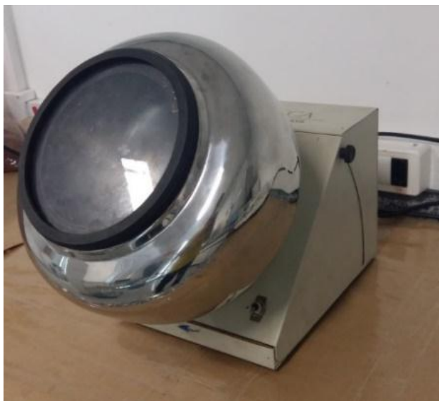
Figura 5. Drageadeira utilizada para o revestimento dos grânulos
