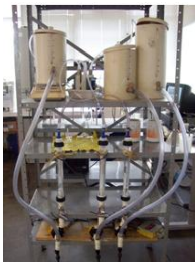
Figura 7 – Planta piloto de eletrodialise e empilhamento de membranas PCCell
