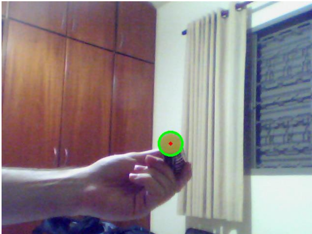
Figura 15: Círculo detectado pela transformada de Hough.
