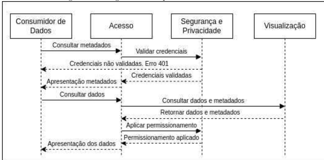
Figura 15: Diagrama de Sequencia da camada de acesso.
