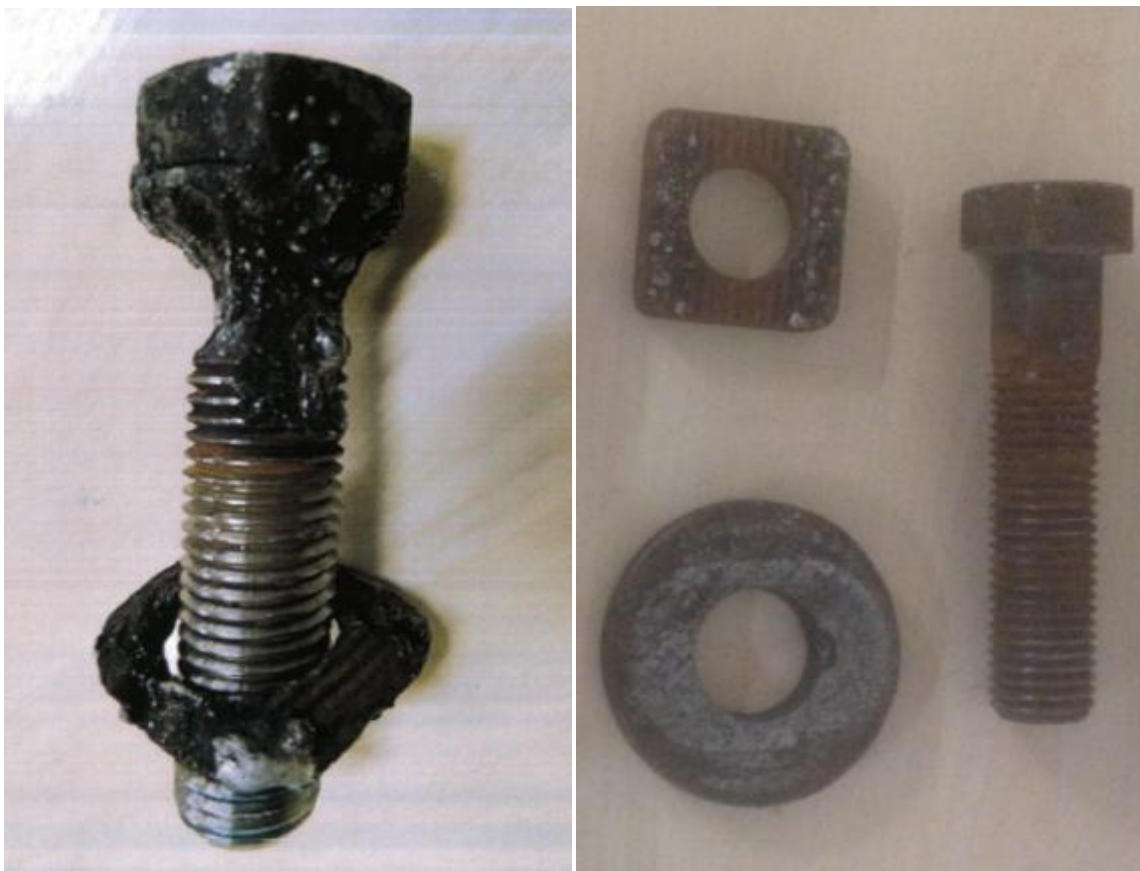
Figura 5 - Caso 1: Perda de material nos elementos de fixação. Fonte: O próprio autor, 2016.
