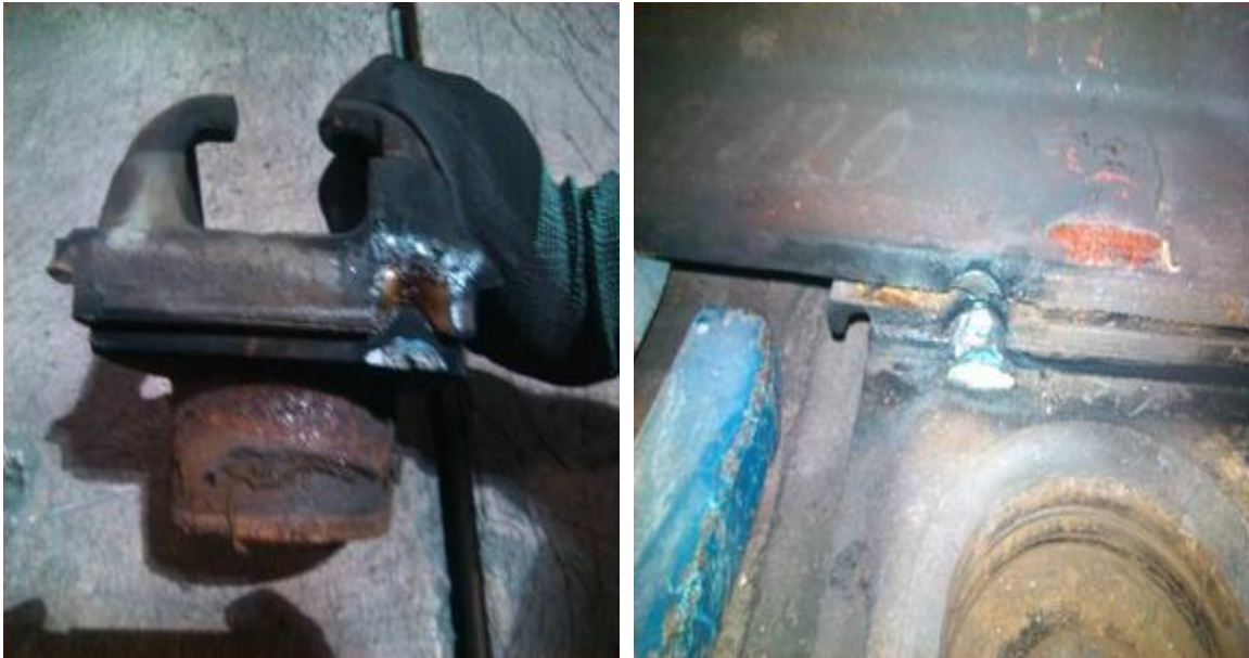
Figura 9 - Caso 3: Danos causados no Patim do Trilho de Rolamento. Fonte: O próprio autor, 2016.
