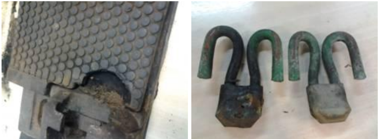
Figura 6 - Caso 2: Base, Placa isolante e Isolação do FastClip. Fonte: O próprio autor, 2016.
