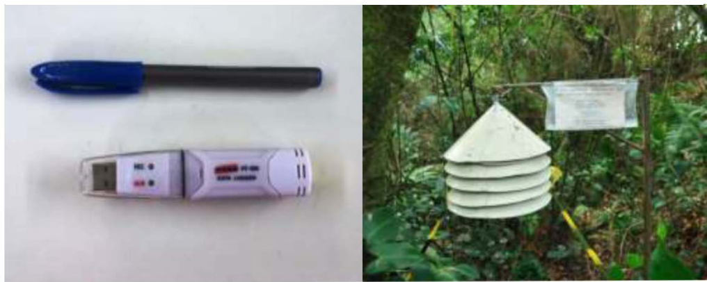
Figura 5 – Datalogger HT500 e mini abrigo meteorológico
