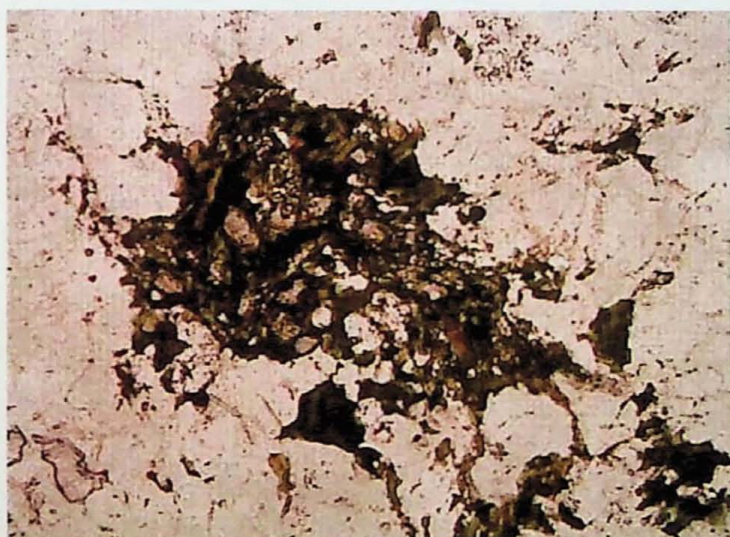
Fotomicrografia 27: Associação entre epidoto e biotita verde, formando pseudomorfo de hornblenda (?). Amostra PI-440. Lado maior = 1,63 mm.
