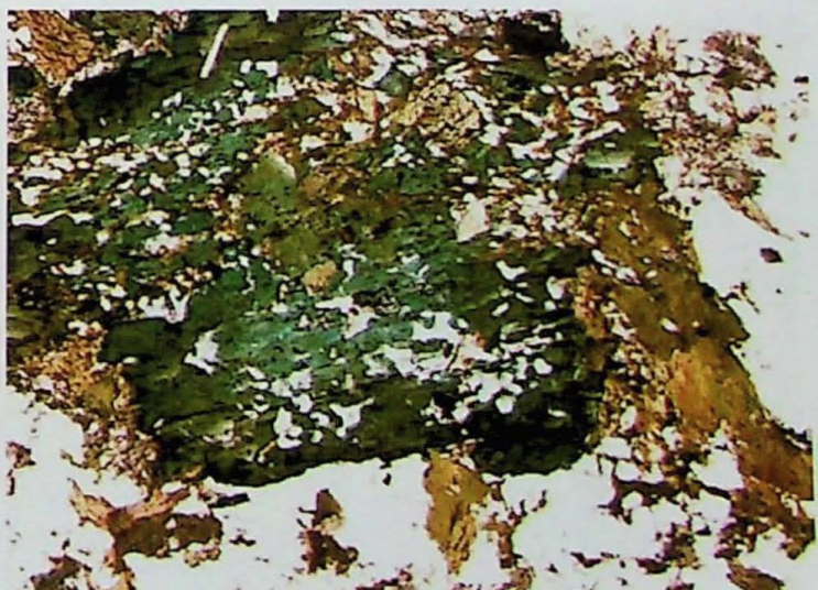
Fotomicrografia 18: Megacristal de hornblenda zonado, com núcleo mais claro em relação à borda, e com abundantes inclusões de quartzo. Borda mais escura e sem inclusões, com presença de biotita secundária. Amostra PI-419. Lado maior = 3,25 mm.
