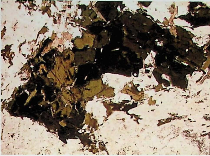
Fotomicrografia 7: Aglomerado de cristais máficos (Bt e Hbl). Amostra PI-8/1. Lado maior = 3,2 mm.
