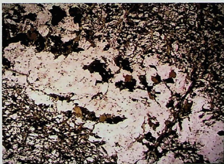
Fotomicrografia 35: Venulação félsica invadindo unidade méfica. No canto inferior direito, pequena zona de cisalhamento com orientação perpendicular à orientação da venulação. Amostra PI-97. Lado maior = 10,2 mm.
