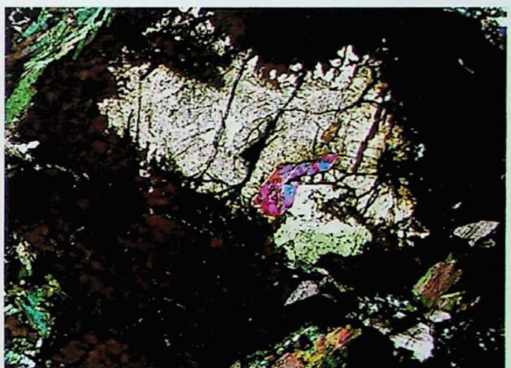
Fotomicrografia 16: Idem à fotomicrografia anterior, com polarizadores cruzados. O núcleo incolor permanece incolor. Ressalta-se a inclusão de epidoto (mineral de birrefringência alta). Amostra PI-112B. Lado maior = 3,2 mm.
