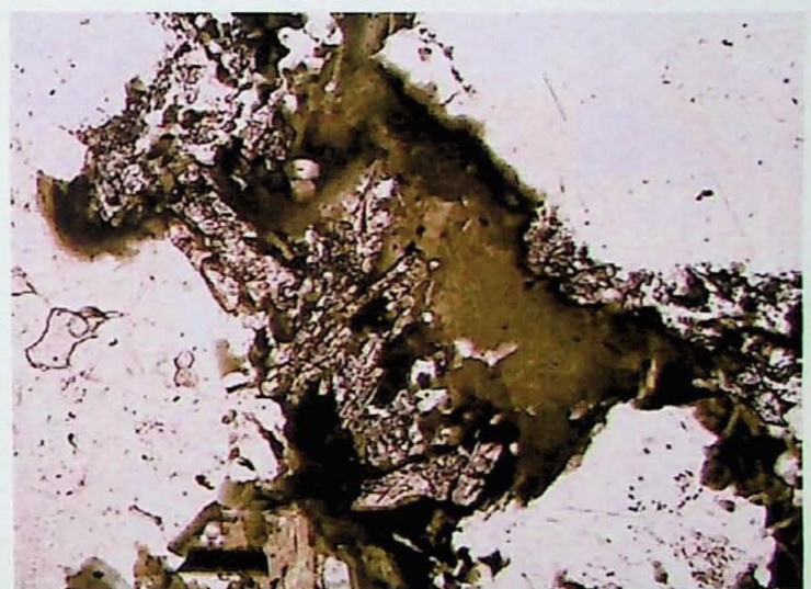
Fotomicrografia 28: Associação entre epidoto e biotita verde. O cristal de biotita é xenomórfico e apresenta bordas recristalizadas. No centro, abaixo, com relevo alto, inclusão de zircão. Amostra PI-270E. Lado maior = 1,3 mm.
