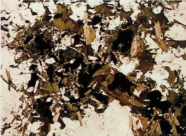
Fotomicrografia 9: Detalhe da fotomicrografia anterior, demonstrando que não há orientação preferencial dos cristais. A maioria dos cristais de Bt parece ser tardia em relação à Hbl. Amostra PI-8/1. Lado maior = 3,2 mm.
