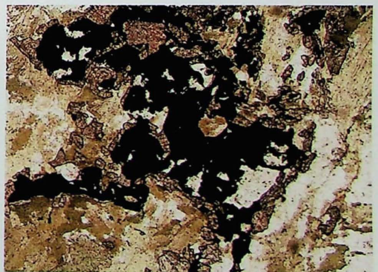
Fotomicrografia 30: Minerais opacos anedrais, provavelmente ilmenita, manteados por titanita. Amostra PI-112B. Lado maior = 1,3 mm.
