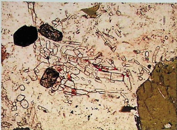
Fotomicrografia 31: Abundância de cristais de apatita em meio aos minerais félsicos. Associam-se ainda cristais euédricos de zircão e um mineral opaco euédrico (magnetita?) Amostra PI-147AB. Lado maior = 1,3 mm.
