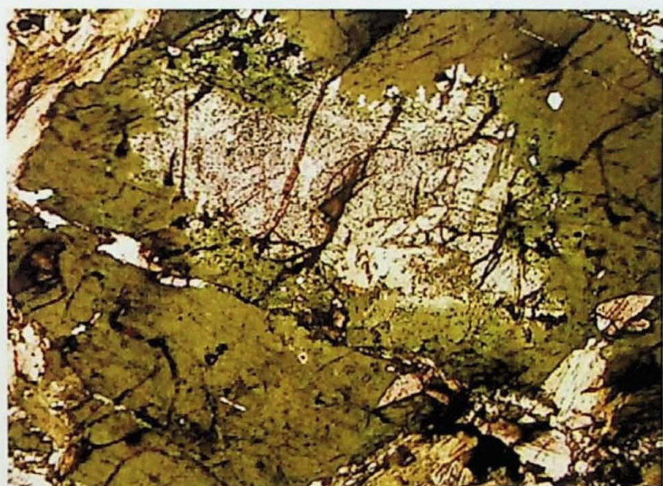
Fotomicrografia 15: Cristal de hornblenda, com bordas irregulares, núcleo incolor (actinolítico?) e inclusões. Amostra PI-112B. Lado maior = 3,2 mm.
