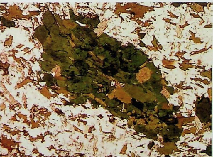
Fotomicrografia 5: Associação de cristais de hornblenda e biotita, formando um conjunto similar a um grande cristal de hornblenda ( pseudomorfo ). Amostra PI-136. Lado maior = 2,6 mm.
