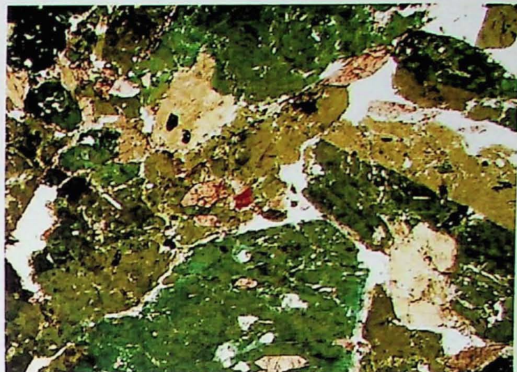
Fotomicrografia 20: Cumulato de cristais sub-édricos de hornblenda, com inclusões de minerais opacos (ilmenita?), titanita e apatita. Amostra PI-147AC veio sienítico em monzodiorito. Lado maior = 10,2 mm.
