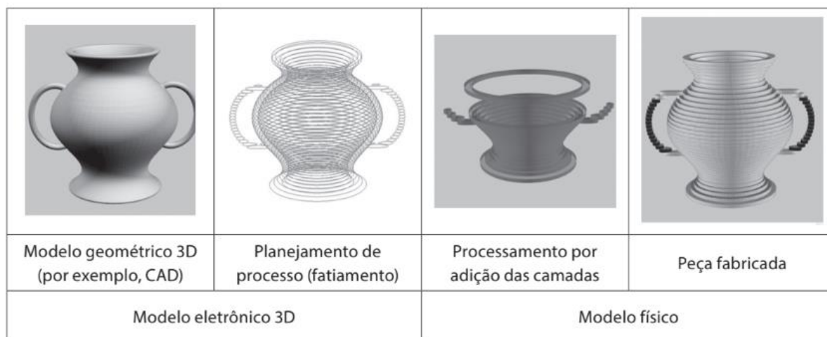
Figura 1- Representação das principais etapas do processo de MA ou impressão 3D. (VOLPATO, 2016)
