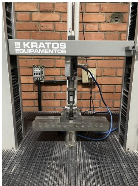
Figura 13 - Ensaio de flexão em três pontos
