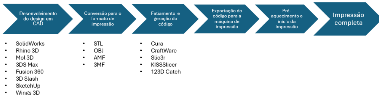
Figura 2 - Processo simplificado de manufatura aditiva incluindo diferentes tipos de softwares usados na indústria
