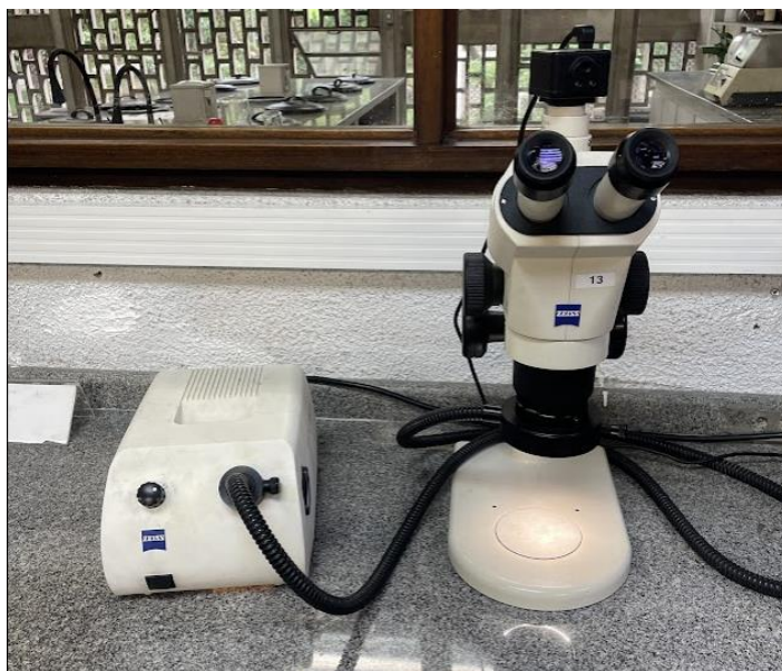
Figura 14 - Lupa estereoscópica Zeiss Stemi SV6, disponível no laboratório de metalurgia (PMT/EPUSP). Fonte: Autor (2025)
