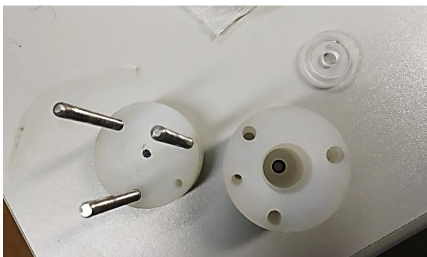
Figura 16. Célula de Corrosão, desmontada, vista de cima
