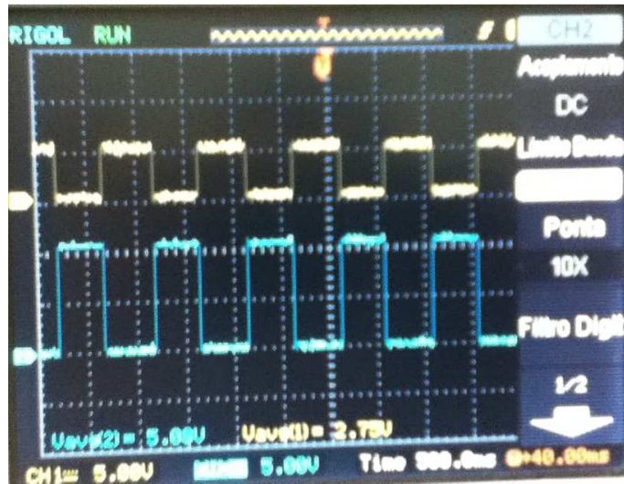
Figura 4.13: Sinal de acionamento do LED vermelho e sinal de controle do S&H vermelho
