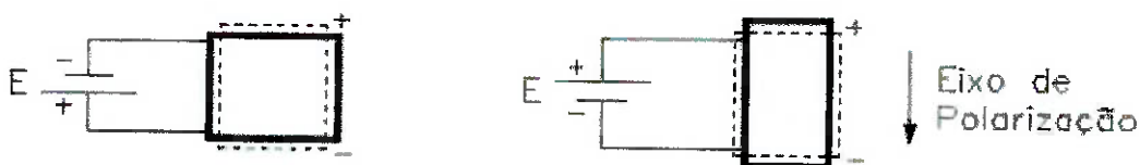
Fig. 2 - Cerâmicas Piezelétricas - Eixo de Polarização
