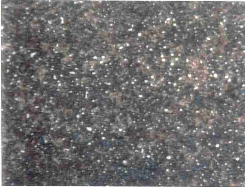
Figura 29: Micrografia do aço DIN 100 Cr 6 temperado e revenido. Amostra D2 Austenitização: 828 °C por 90 min. Ataque Nital. 1400 x.
