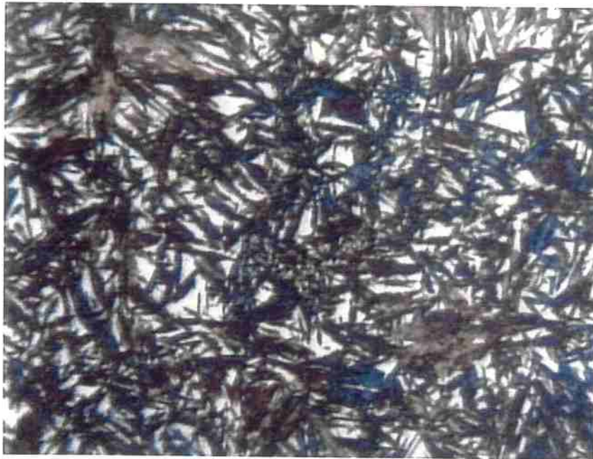
Figura 31: Micrografia do aço DIN 100 Cr 6 temperado e revenido. Amostra D4 Austenitização: 970 °C por 90 min. Ataque Nital. 1400 x.
