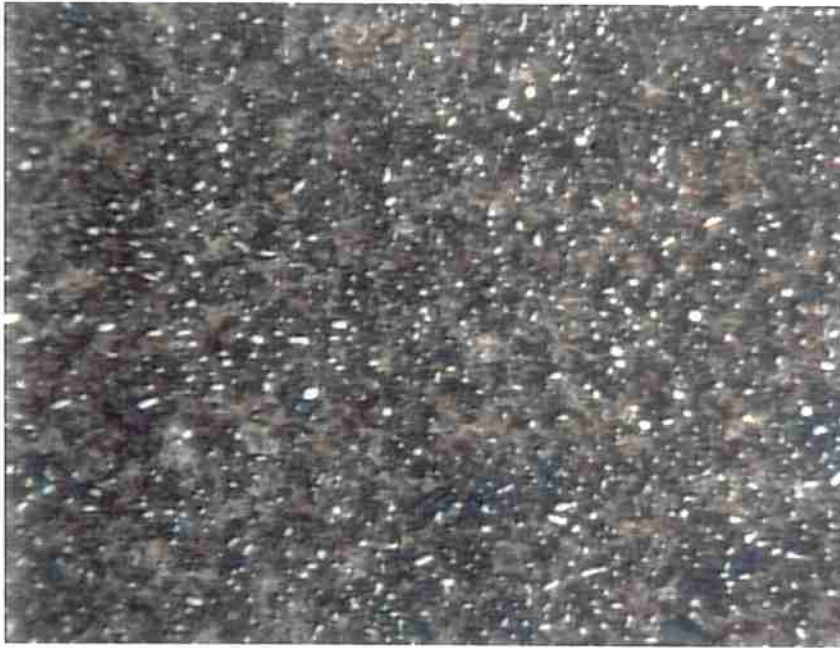
Figura 7: Micrografia do aço DIN 100 Cr 6 temperado e revenido. Amostra A1 Austenitização: 803 °C por 30 min. Ataque Nital. 1400 x.
