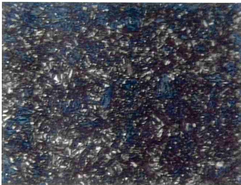
Figura 17: Micrografia do aço DIN 100 Cr 6 temperado e revenido. Amostra B3 Austenitização: 849 °C por 45 min. Ataque Nital. 1400 x.
