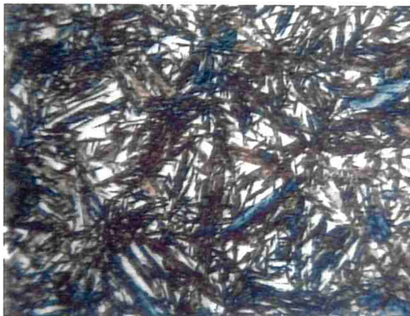
Figura 14: Micrografia do aço DIN 100 Cr 6 temperado e revenido. Amostra A8 Austenitização: 1020 °C por 30 min. Ataque Nital. 1400 x.
