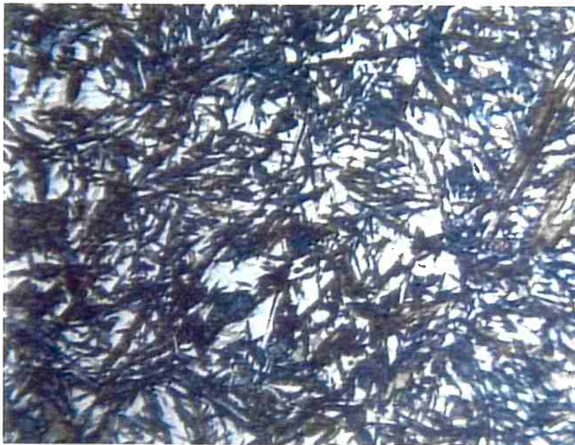
Figura 32: Micrografia do aço DIN 100 Cr 6 temperado e revenido. Amostra D5 Austenitização: 1000 °C por 90 min. Ataque Nital. 1400 x.
