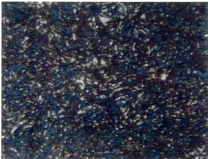
Figura 24: Micrografia do aço DIN 100 Cr 6 temperado e revenido. Amostra C4 Austenitização: 880 °C por 60 min. Ataque Nital. 1400 x.
