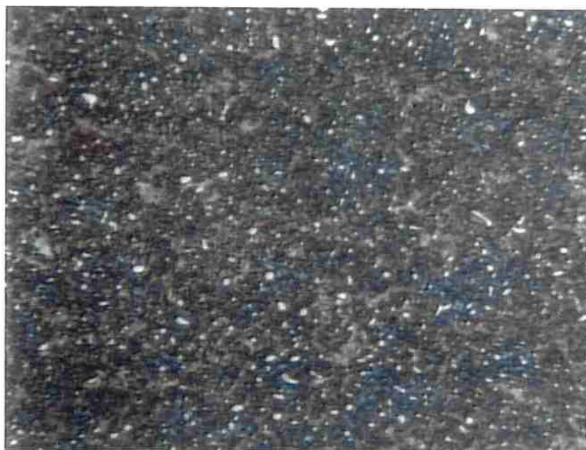
Figura 28: Micrografia do aço DIN 100 Cr 6 temperado e revenido. Amostra D1 Austenitização: 785 °C por 90 min. Ataque Nital. 1400 x.
