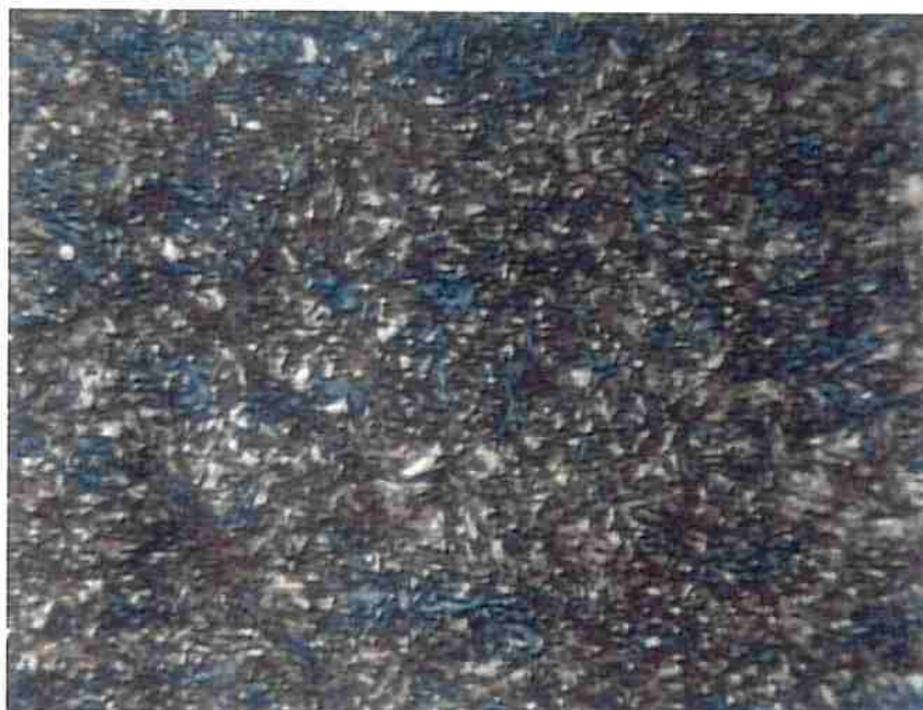
Figura 11: Micrografia do aço DIN 100 Cr 6 temperado e revenido. Amostra A5 Austenitização: 912 °C por 30 min. Ataque Nital. 1400 x.
