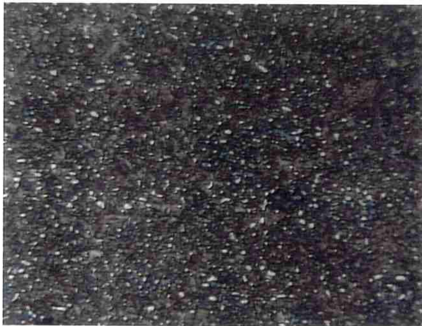
Figura 15: Micrografia do aço DIN 100 Cr 6 temperado e revenido. Amostra B1 Austenitização: 792 °C por 45 min. Ataque Nital. 1400 x.
