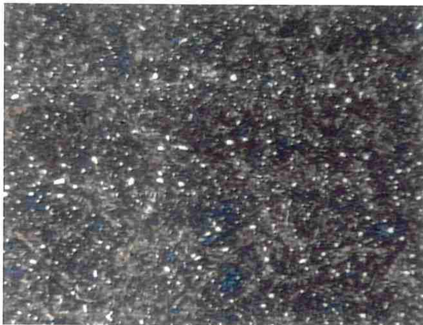
Figura 23: Micrografia do aço DIN 100 Cr 6 temperado e revenido. Amostra C3 Austenitização: 854 °C por 60 min. Ataque Nital. 1400 x.
