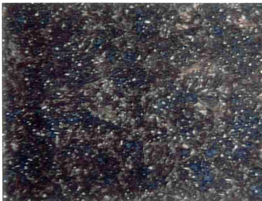
Figura 10: Micrografia do aço DIN 100 Cr 6 temperado e revenido. Amostra A4 Austenitização: 904 °C por 30 min. Ataque Nital. 1400 x.
