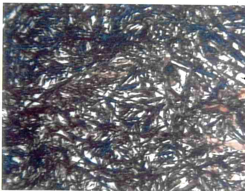
Figura 12: Micrografia do aço DIN 100 Cr 6 temperado e revenido. Amostra A6 Austenitização: 938 °C por 30 min. Ataque Nital. 1400 x.
