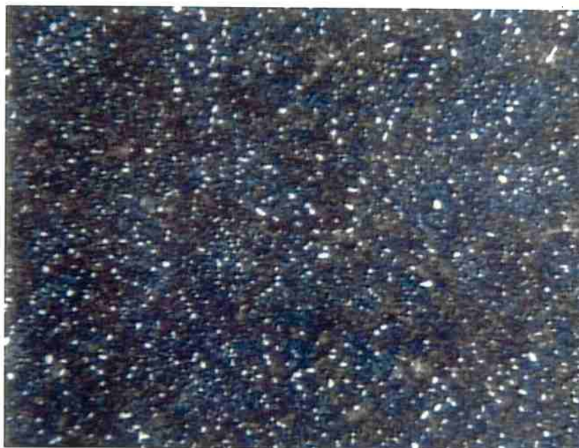
Figura 16: Micrografia do aço DIN 100 Cr 6 temperado e revenido. Amostra B2 Austenitização: 820 °C por 45 min. Ataque Nital. 1400 x.
