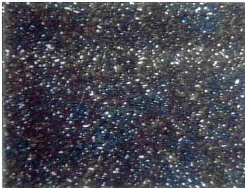
Figura 22: Micrografia do aço DIN 100 Cr 6 temperado e revenido. Amostra C2 Austenitização: 803 °C por 60 min. Ataque Nital. 1400 x.
