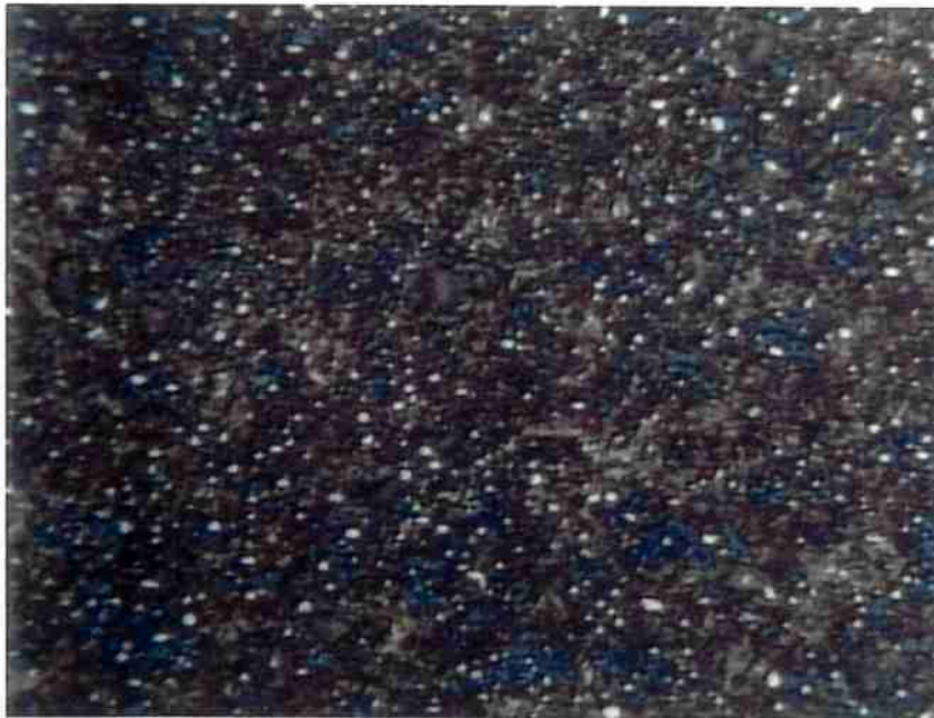
Figura 8: Micrografia do aço DIN 100 Cr 6 temperado e revenido. Amostra A2 Austenitização: 830 °C por 30 min. Ataque Nital. 1400 x.
