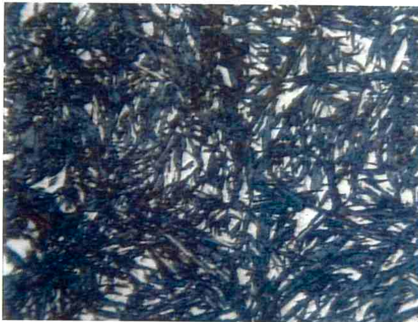
Figura 26: Micrografia do aço DIN 100 Cr 6 temperado e revenido. Amostra C6 Austenitização: 1000 °C por 60 min. Ataque Nital. 1400 x.
