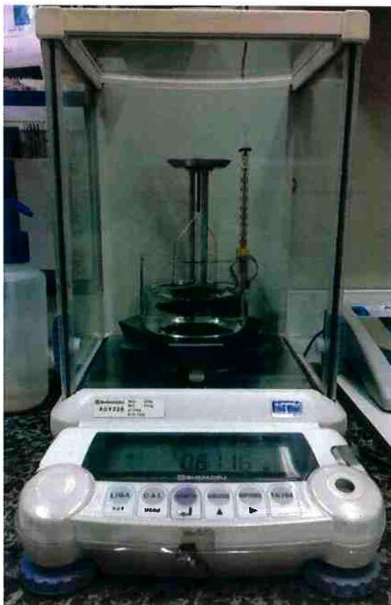
Figura 10. Balança Shimadzu AUW, com a massa do corpo de prova sendo medida dentro do líquido.
