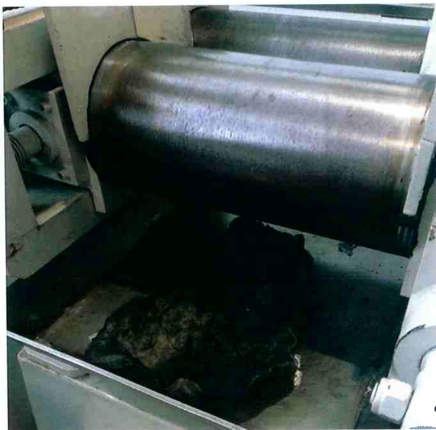
Figura 8. Foto da incorporação do pó ao SBR por meio de um misturador de cilindro aberto de 2 rolos.
