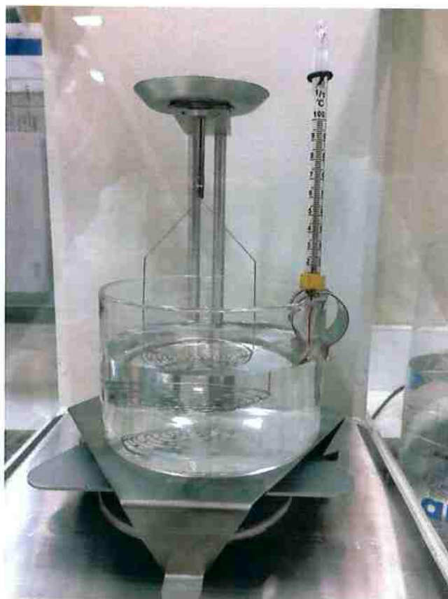
Figura 9. Foto do kit de medida de gravidade específica que acompanha a balança Shimadzu AUW.
