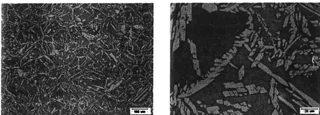
Figura 59: AID UNS S32750 submetido aos tratamentos térmicos de ferritização e reaquecimento a 1200°C por 1s.
