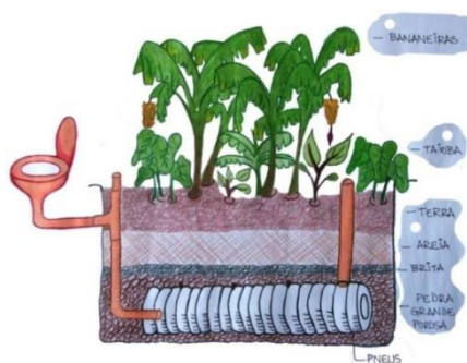
Figura 16: Esquema de tratamento do tanque de evapotranspiração.
