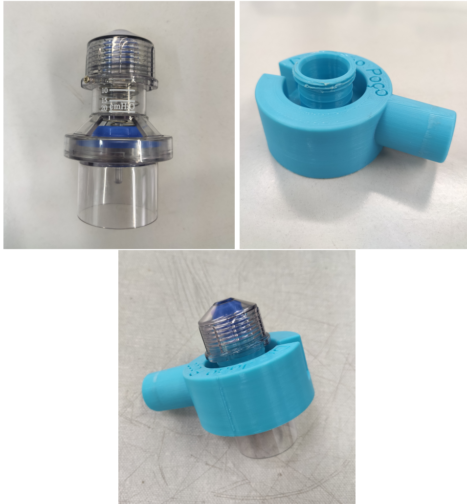
Figura 15: Componentes da válvula, sendo que tem-se, de cima para abaixo: a válvula original, a peça fabricada por manufatura aditiva, e a válvula de PIPr montada.
