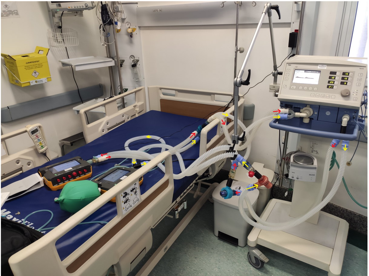
Figura 18: Circuito montado para o ensaio em que são utilizadas válvulas tanto na parte inspiratória quanto na parte expiratória. Os fluxos estão esquematizados em amarelo (pulmão 1) e vermelho (pulmão 2).
