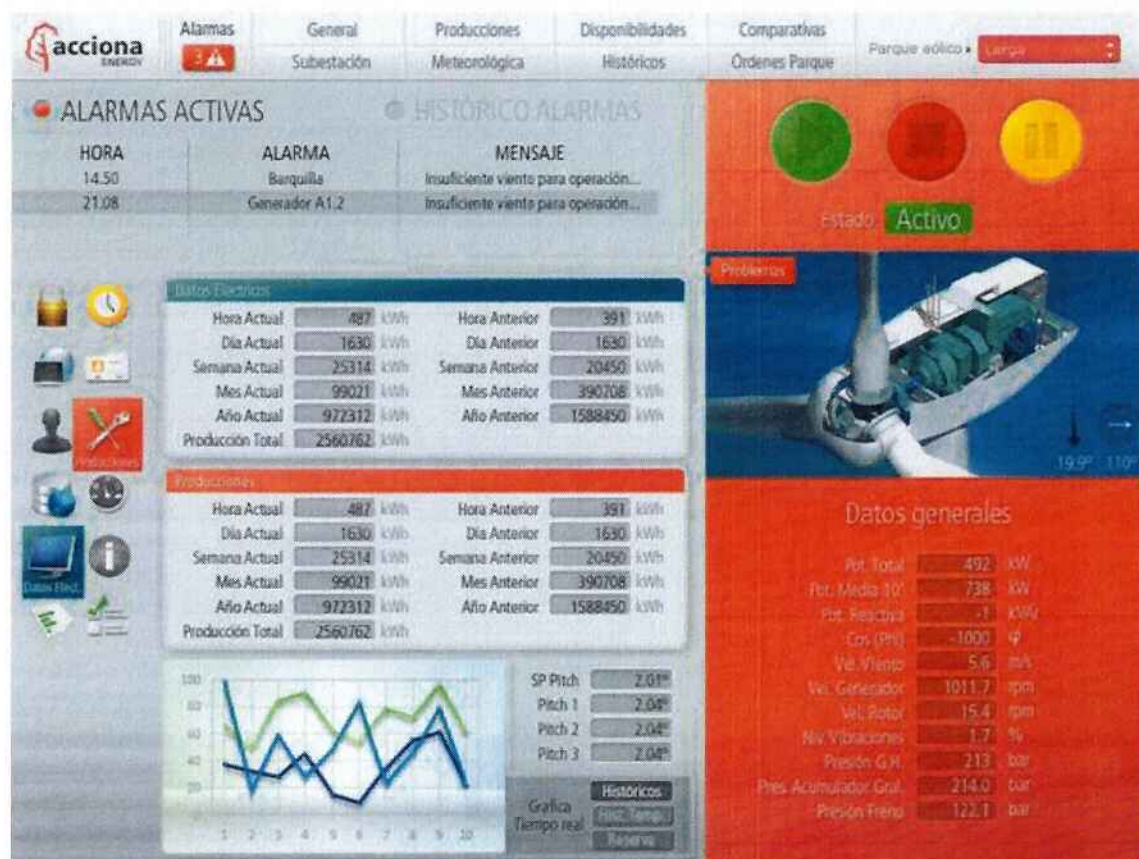
Figura 2: Exemplo de SCADA de um gerador eólico. Fonte: [9]
