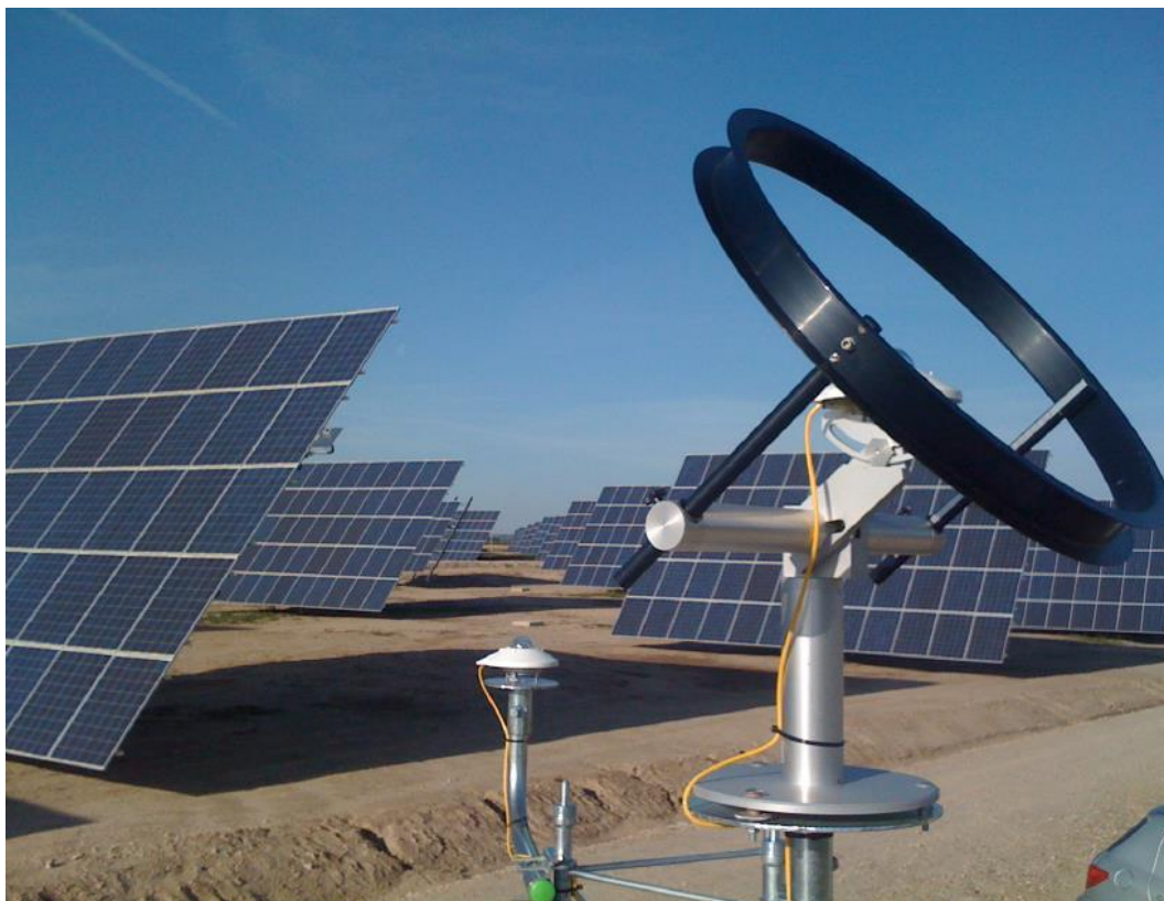
Figura 2.10 - Estação meteorológica de uma central fotovoltaica com seguidor solar
