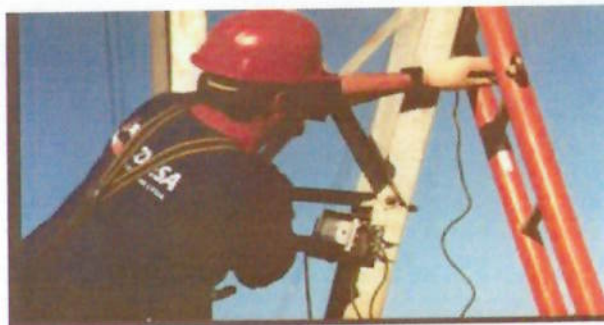
Figura 19 – Instalação de micro amperímetro para medição corrente de fuga
