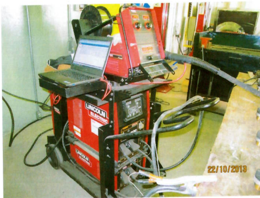
Figura 4.4: Foto ilustrativa da configuração do equipamento de soldagem. MIG pulsado e transferência controlada por curto-circuito STT.
