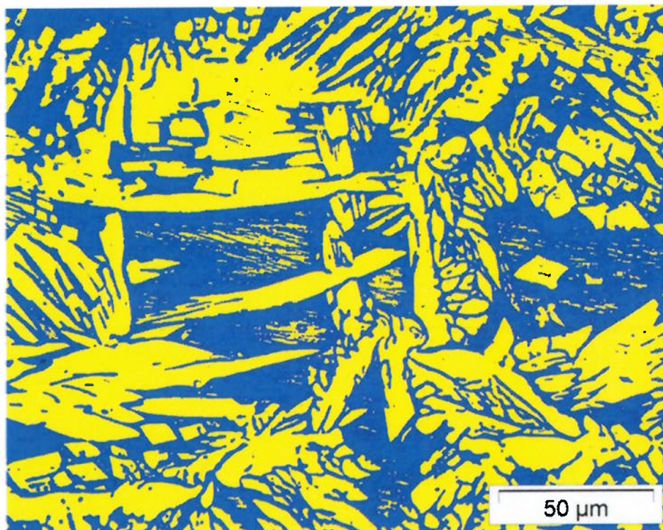
Figura 5.18: Micrografia para contagem de ferrita da raiz do metal de solda, do conjunto soldado de teste B, soldada na raiz com o processo MIG STT e enchimento com o MIG pulsado. Ferrita 47%.
