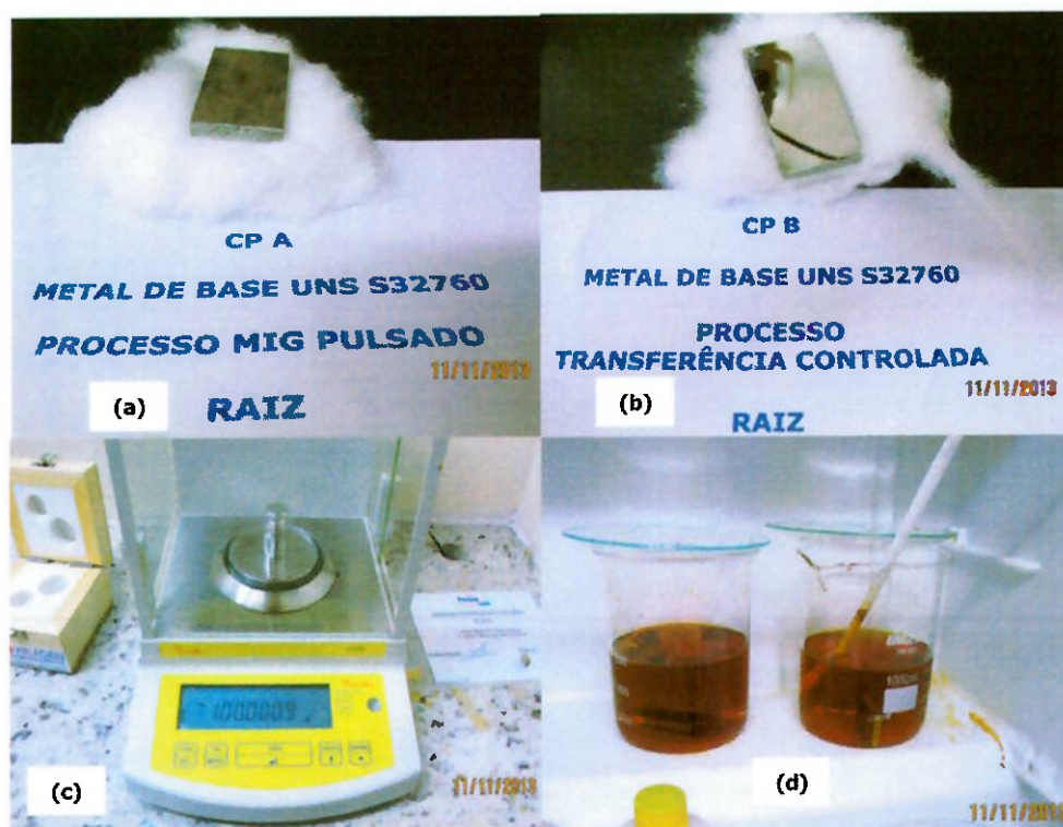
Figura 4.6: Fotos ilustrativas em (a) e (b) os CP's para o ensaio de corrosão, em (c) balança de precisão e (d) CP's imersos nas soluções para início do ensaio, conforme ASTM G-48, método A.
