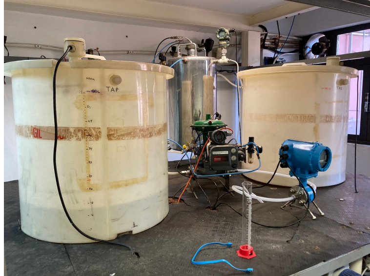
Figura 3: Tanques de Ácido Principal e Secundário localizados na parte Superior da Planta de Controle de pH
