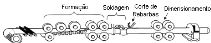
Figura 2-5 – Representação do Processo de Fabricação de Tubos. Adaptado de InoxTubos.
