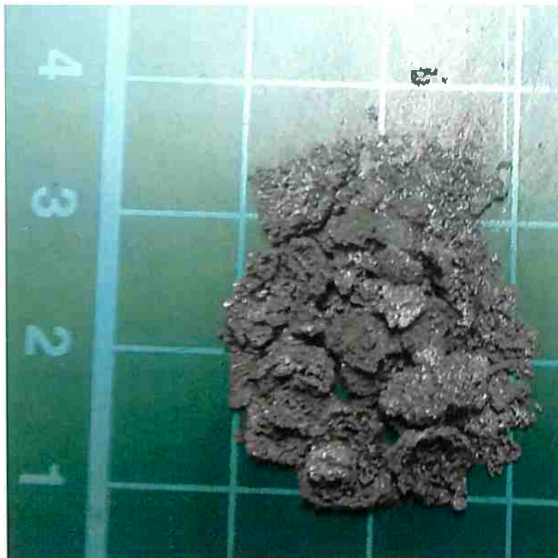
Figura 10: Amostra de aglomerado 3 com 78% de pellet feed e 22% de carvão vegetal com adição de 20% de emulsão asfáltica reduzida em ensaio termogravimétrico isotérmico a 1150°C. Cada lado do quadriculado na figura corresponde a 1cm.
