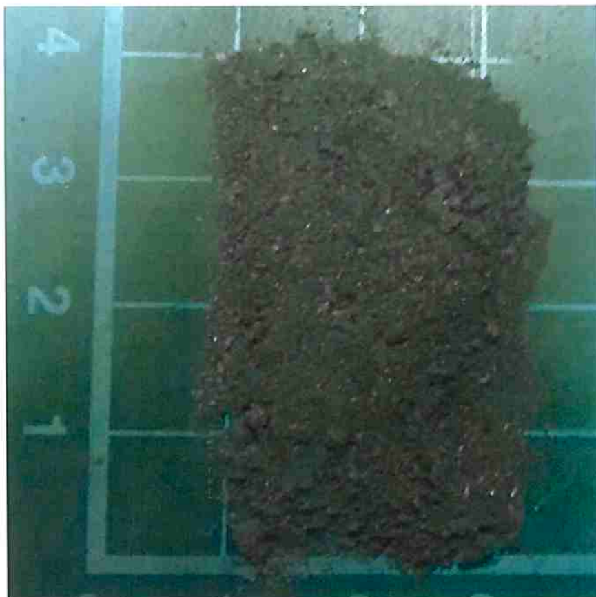
Figura 7: Amostra de aglomerado 1 com composição 75% pellet feed , 22% de carvão vegetal e com adição de 0,5% de CMC após redução a 950°C em ensaio termogravimétrico isotérmico. Cada lado do quadriculado na figura equivale a 1 cm.
