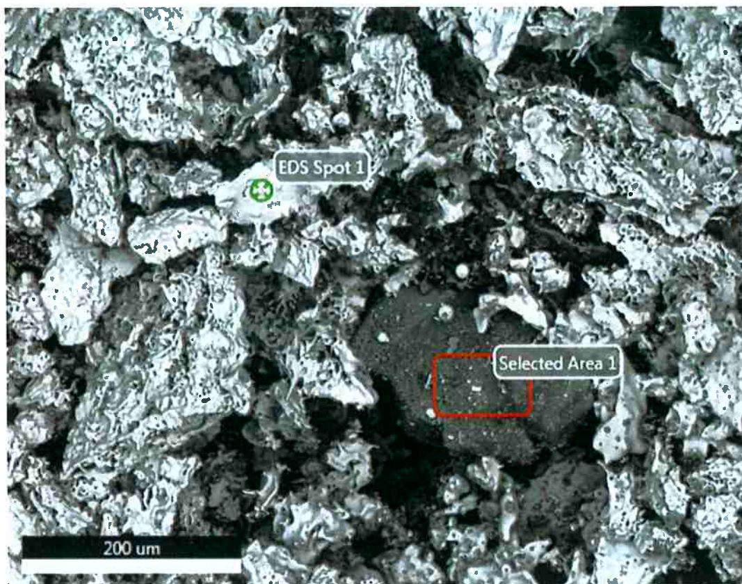
Figura 29: Micrografia com aumento 500x em MEV da região intermediária do aglomerado 6 com composição de 85% pellet feed , 15% carvão vegetal e com adição de 30% farinha de arroz reduzida não isotermicamente até 1250°C.
