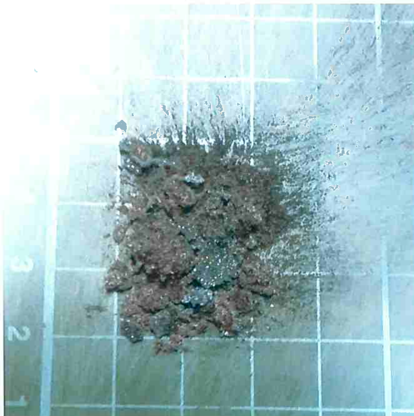
Figura 21: Amostra do aglomerado 6 -(78% de pellet feed , 22% de carvão e com adição de 30% de farinha de arroz)- obtida no ensaio termogravimétrico não isotérmico com taxa de 10°C/min com
