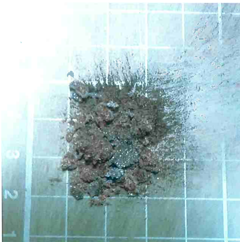
Figura 15: Amostra de aglomerado 6 com 78% de pellet feed , 22% de carvão vegetal e com adição de 30% de farinha de arroz reduzida a 1150°C em ensaio termogravimétrico isotérmico após ser tratada em patamar isotérmico a 300°C. Cada lado do quadriculado da figura corresponde a 1 cm.
