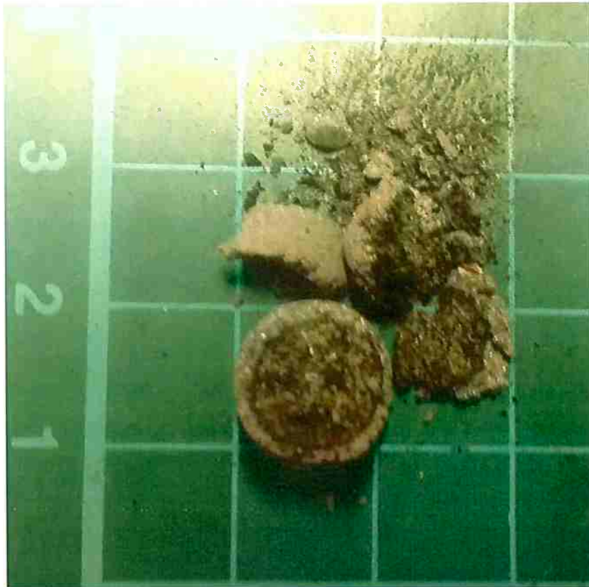
Figura 11: Amostra de briquete do aglomerado 4 com 78% de pellet feed , 22% de carvão vegetal e com adição de 5% de alcatrão reduzida em ensaio termogravimétrico isotérmico a 950°C. Cada lado do quadriculado na figura corresponde a 1 cm.
