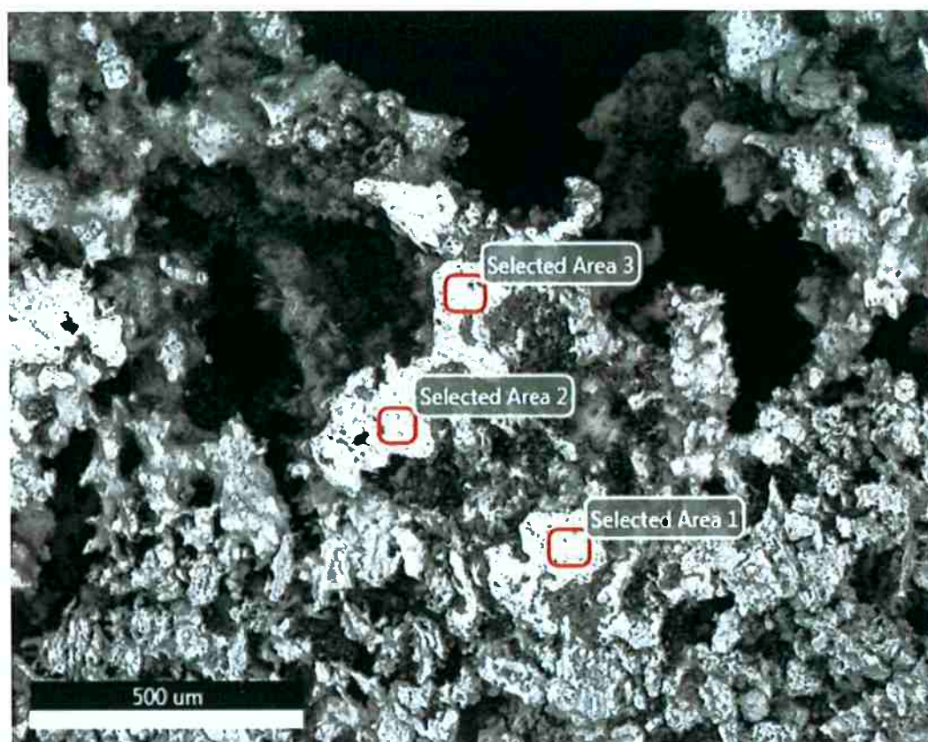
Figura 27: Micrografia de microanálise EDS com aumento de 200x vezes do centro da pelota do aglomerado tipo 6 com composição de 85% pellet feed , 15% carvão vegetal e com adição de 30% farinha de arroz reduzida não isotermicamente até 1250°C.
