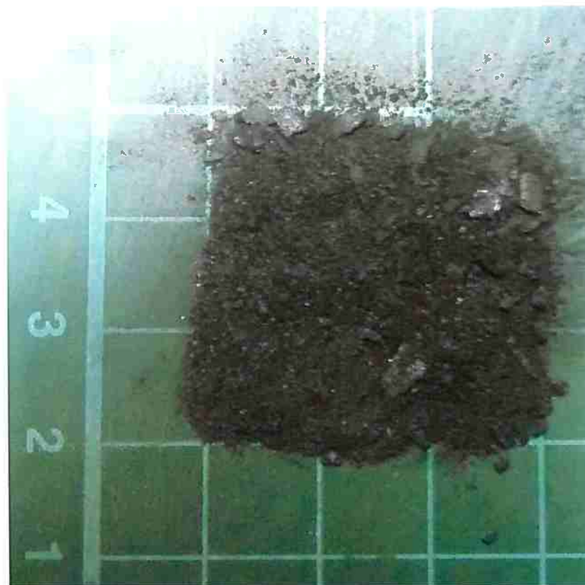
Figura 8: Amostra de aglomerados 2- (78% Pellet Feed , 22% carvão vegetal e com adição de 2% de bentonita), após redução em ensaio termogravimétrico isotérmico a 1150°C. Cada lado do quadriculado na figura equivale a 1 cm.
