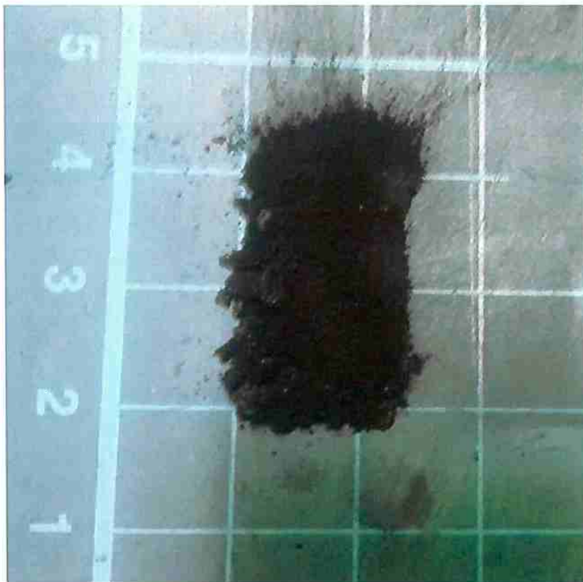
Figura 14: Amostra de aglomerado 5 com 78% de pellet feed , 22% de carvão vegetal e com adição de 2% de cal e de 3% de melaço reduzida a 1150°C em ensaio termogravimétrico isotérmico. Cada lado do quadriculado da figura corresponde a 1 cm.
