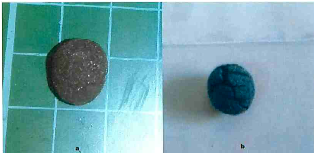
Figura 22: Amostras do aglomerado6 (de composição 85% de pellet feed , 15% de carvão e com adição de 30% de farinha de arroz) reduzidas não isotermicamente a uma taxa de 10°C/min.; (a) aquecida até 1150°C e (b) aquecida até 1250°C.
