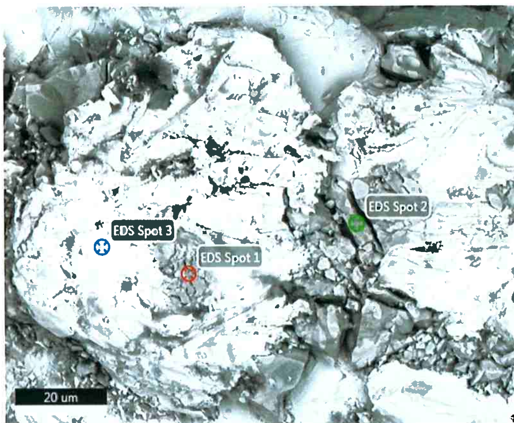
Figura 31: Micrografia de microanálise EDS com aumento de 3000x vezes da região intermediária do aglomerado 6 com composição de 85% pellet feed, 15% carvão vegetal e como adição de 30% farinha de arroz reduzida não isotermicamente até 1250°C.
