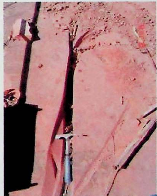
Fotos 1 e 2: Sulcos no arenito Aquidauana provocado pelo atrito causado com a vibração
