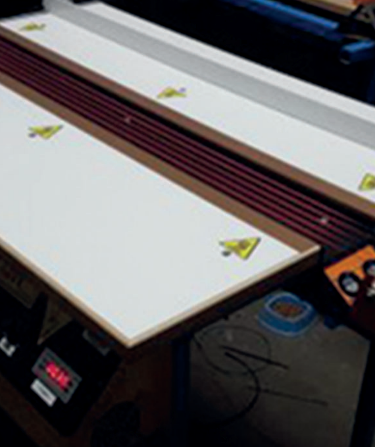
FIGS. 9 E 10: MÁQUINA DE CURVAR ACRÍLICO. Equipamento da Acryflon® modelo MVA B P 2BM 10F
