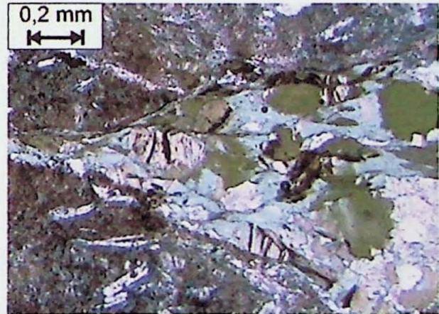
Foto 18 – Detalhe da deformação das rochas vulcânicas com estiramento de amígdalas.
