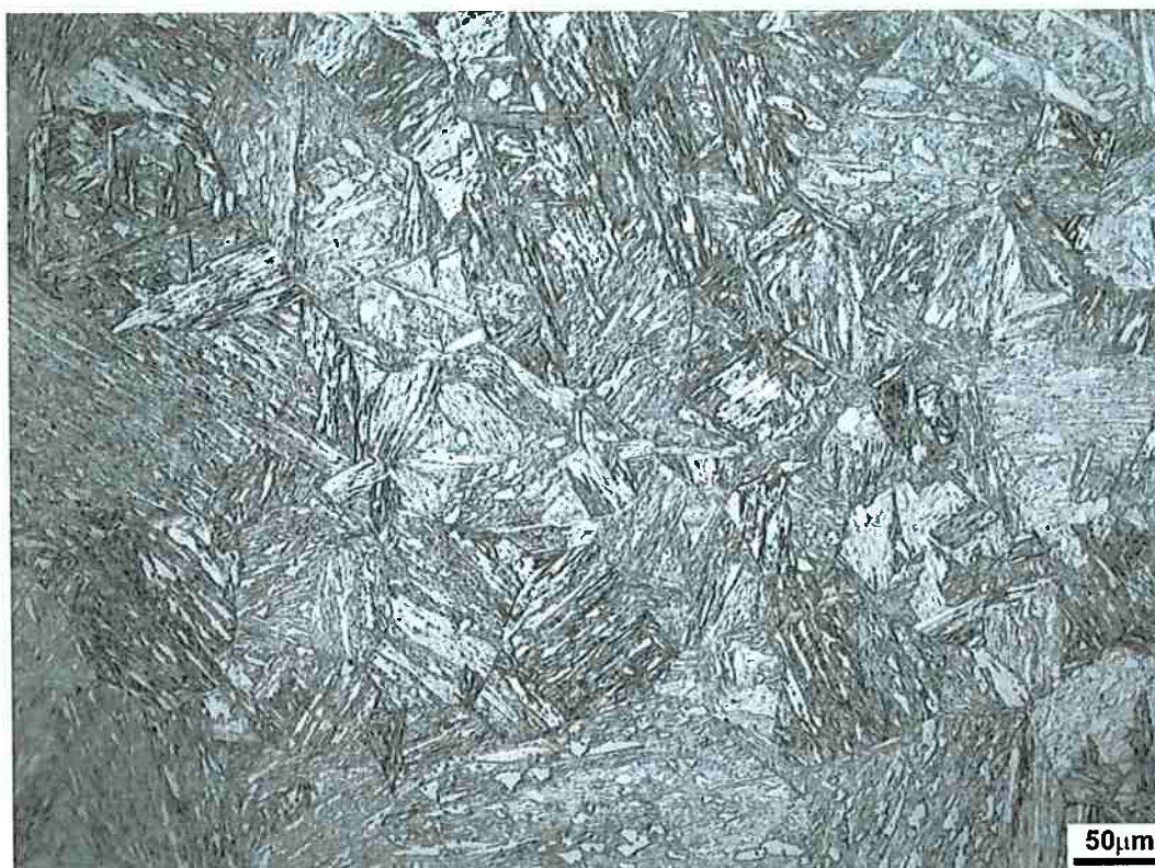
Figura 6 Microscopia com 200x de aumento realizada em microscópio óptico com ataque ácido com Nital 2%, em amostra de aço ASTM A553 que sofreu ciclo térmico de 1250°C. [12]
