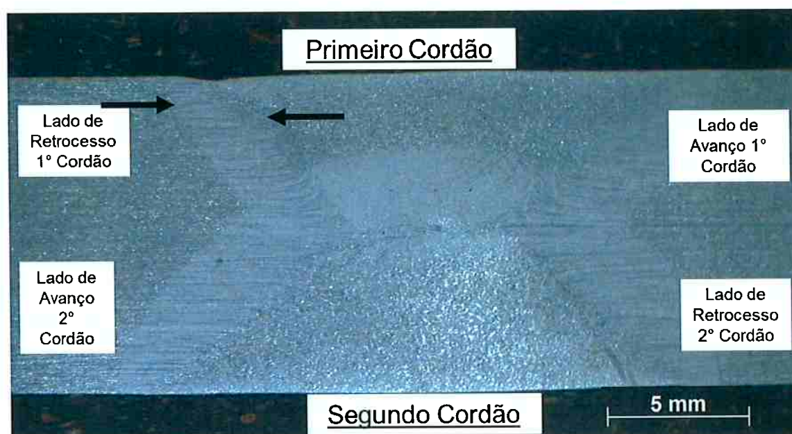
Figura 16 Macrografia do CP 2, amostra soldada tratada termicamente a 685°C
