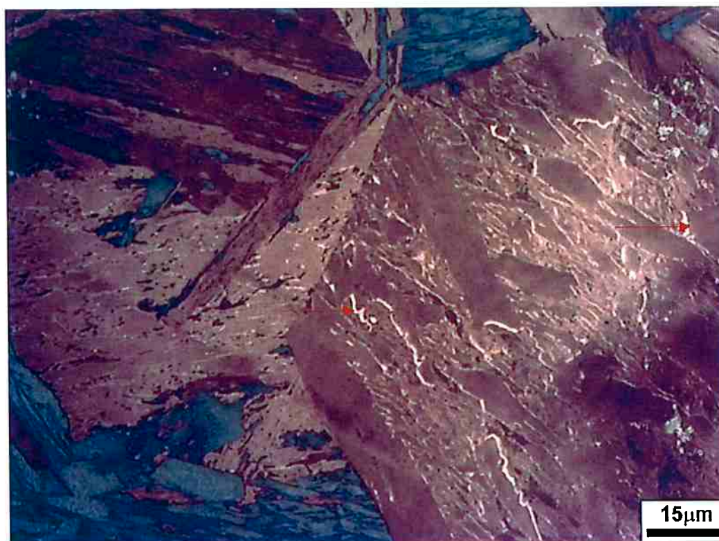
Figura 9 Micrografia de amostra de aço ASTM A553 sob efeito de ciclo térmico de 1250°C, em microscópio óptico, com aumento de 1000x, e tratamento com reagente Klemm, a fase austenita retida está evidenciada por setas vermelhas [12]
