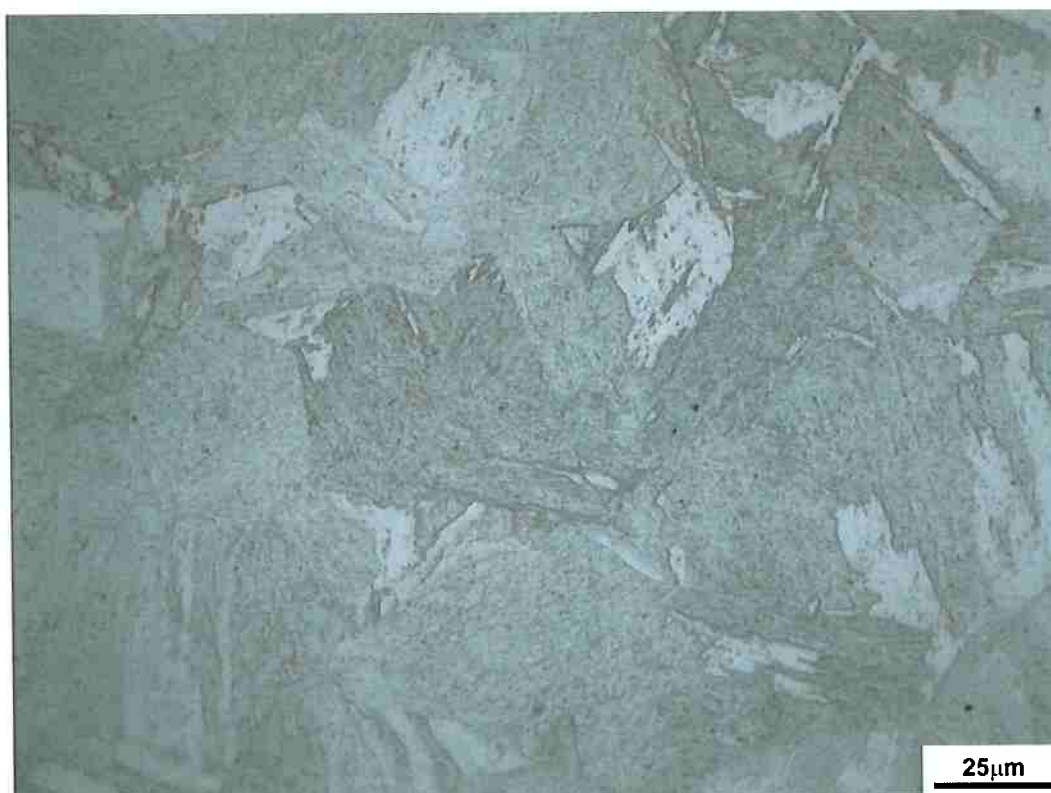
Figura 23 Microscopia óptica do CP 1, tratado termicamente a 1250°C por 600 minutos, área D (área central da zona de mistura). Reagente: Nital 2%. Aumento de 500x
