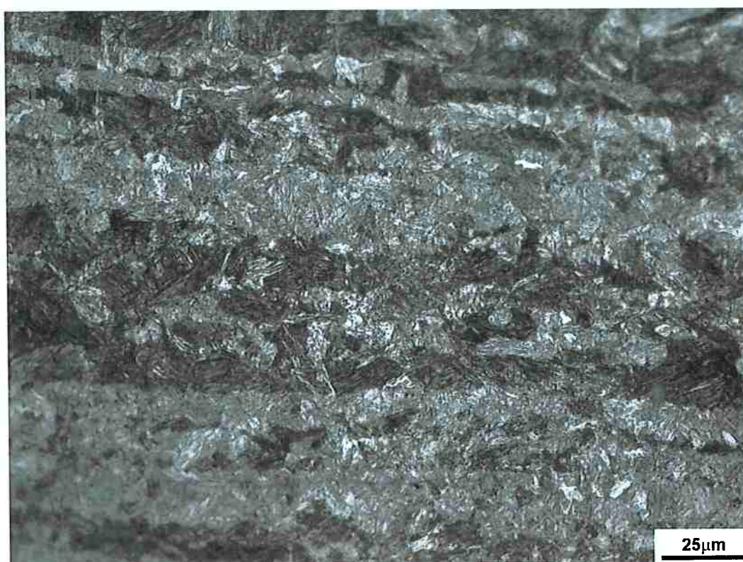
Figura 25 Microscopia óptica do CP 2, tratado termicamente a 685°C por 600 minutos, área A, metal de base. Reagente: Nital 2%. Aumento de 500x
