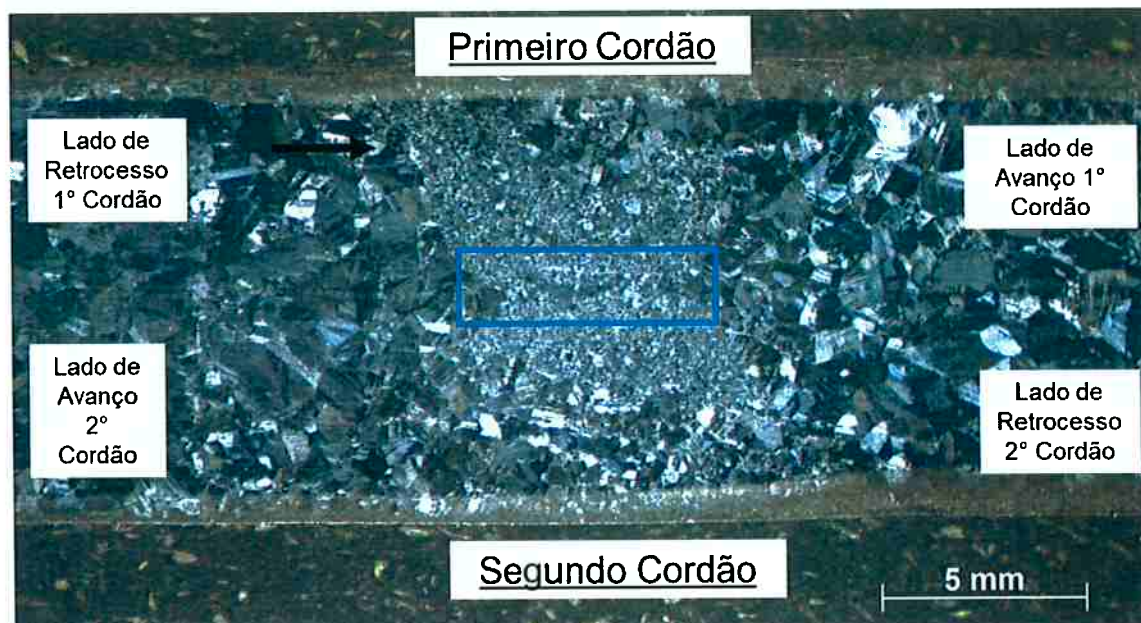
Figura 15 Macrografia de CP 1, amostra soldada tratada termicamente a 1250°C
