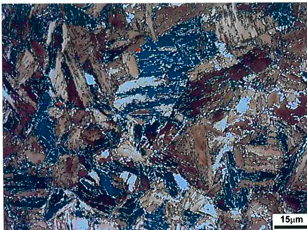
Figura 8 Micrografia de amostra de aço ASTM A553 sem efeito de temperatura, em microscópio óptico, com aumento de 1000x, e tratamento com reagente Klemm, a fase austenita retida está evidenciada por setas vermelhas [12]
