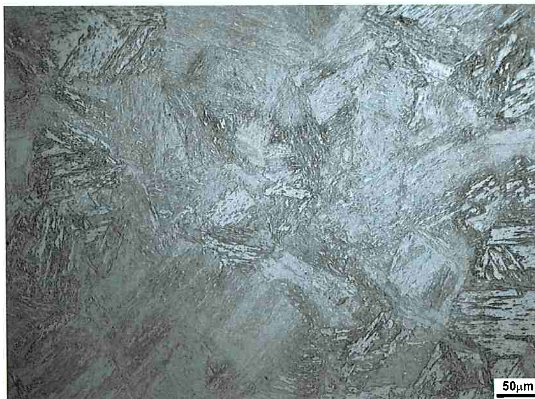
Figura 7 Microscopia com 200x de aumento realizada em microscópio óptico com ataque ácido com Nital 2%, em amostra de aço ASTM A553 que sofreu ciclo térmico de 1250°C seguido de ciclo térmico de 685°C. [12]
