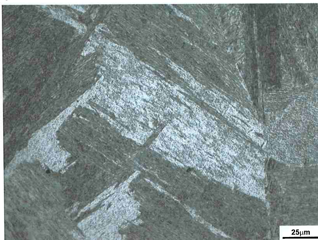
Figura 28 Microscopia óptica do CP 3, tratado termicamente a 1250°C por 600 minutos seguido de tratamento a 685°C por 600 minutos, área A, metal de base. Reagente: Nital 2%. Aumento de 500x
