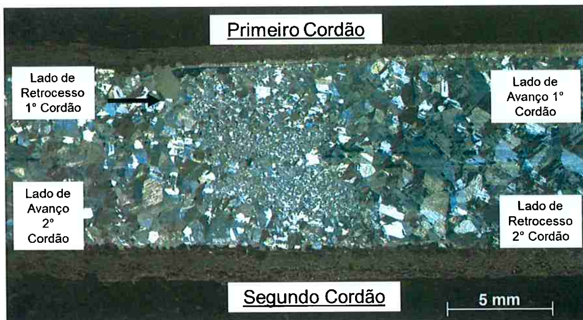
Figura 17 Macrografia do CP 3, amostra soldada tratada termicamente a 1250°C, seguida de tratamento a 685°C
