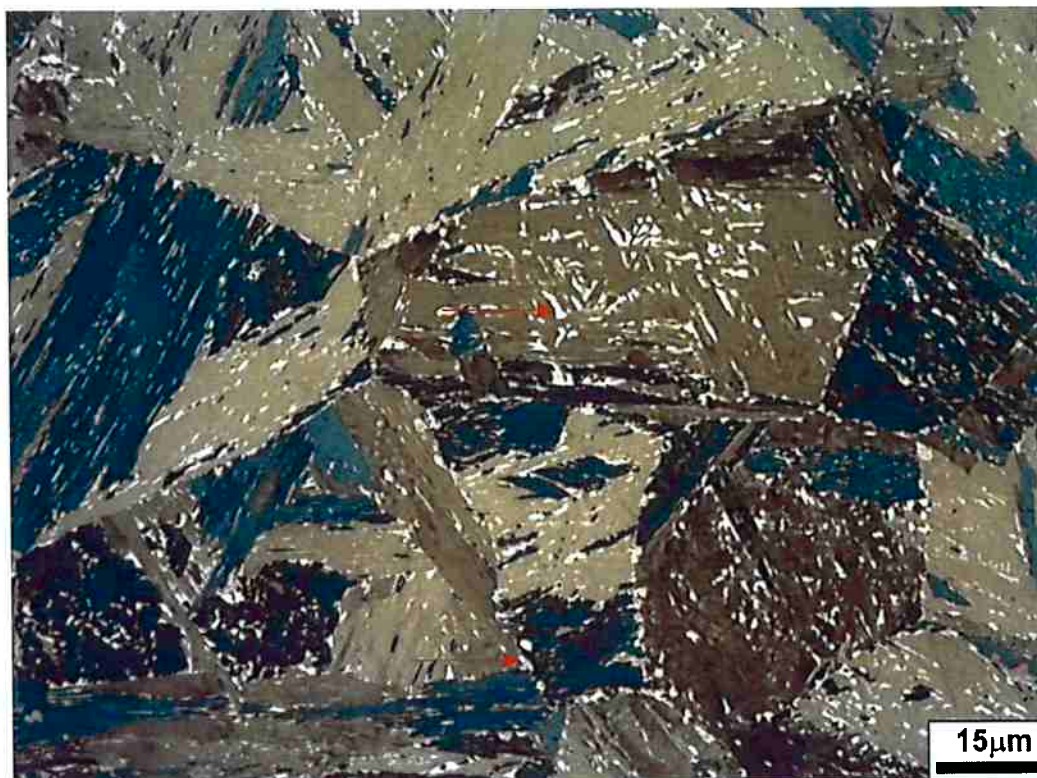
Figura 10 Micrografia de amostra de aço ASTM A553 sob efeito de ciclo térmico de 1250°C, seguido de ciclo térmico a 685°C, em microscópio óptico, com aumento de 1000x, e tratamento com reagente Klemm, a fase austenita retida está evidenciada por setas vermelhas [12]
