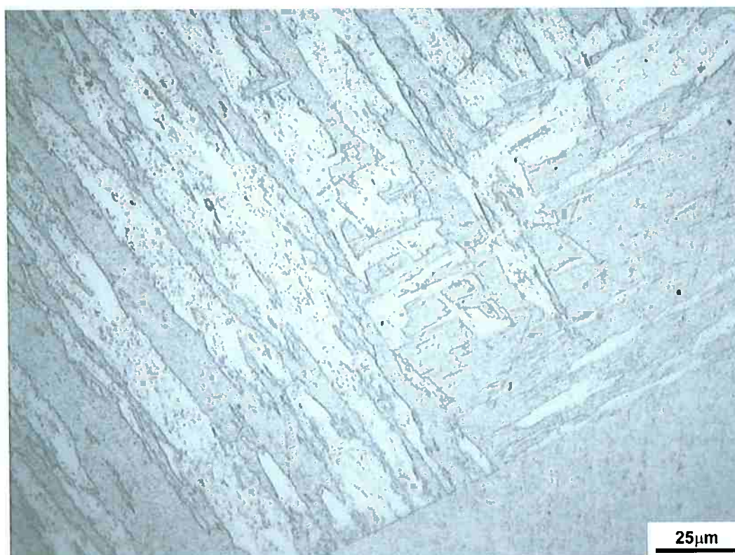
Figura 22 Microscopia óptica do CP 1, tratado termicamente a 1250°C por 600 minutos, área A, metal de base. Reagente: Nital 2%. Aumento de 500x
