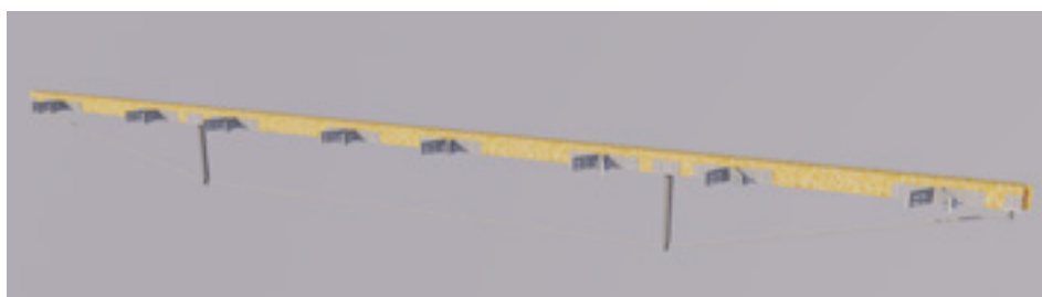
Figura 64: Interfaces da viga com a parede, o pilar e o módulo hexagonal
