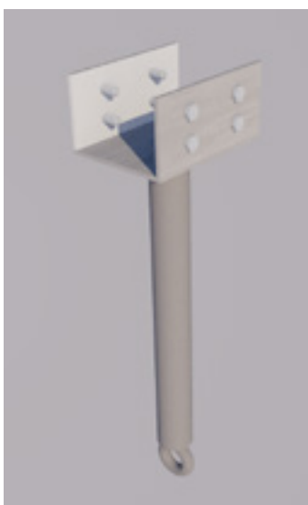
Figura 64: Interfaces da viga com a parede, o pilar e o módulo hexagonal
