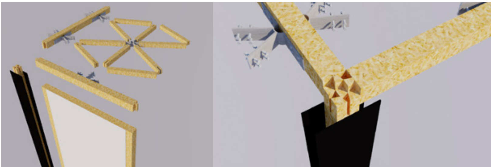
Figura 64: Interfaces da viga com a parede, o pilar e o módulo hexagonal
