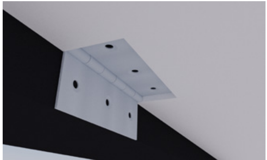
Figura 100: Detalhe da fixação da dobradiça
