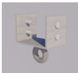
Figura 65: Peça de conexão entre as vigas de madeira e montante da viga vagão
