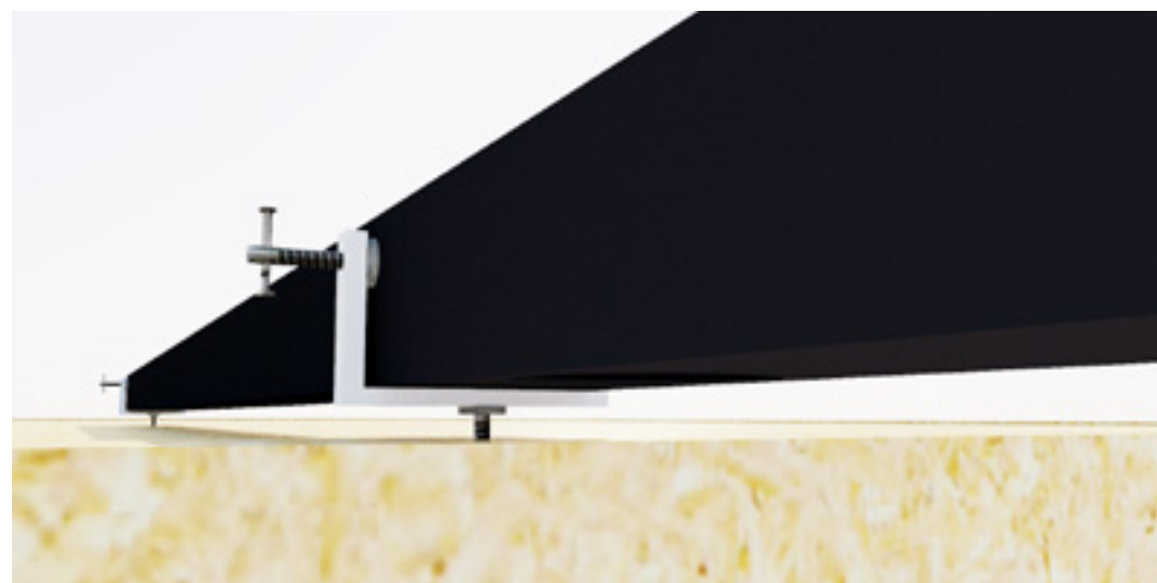
Figura 97: Esquema do balanço do telhado para impedir entrada de chuva pela abertura lateral da cobertura
